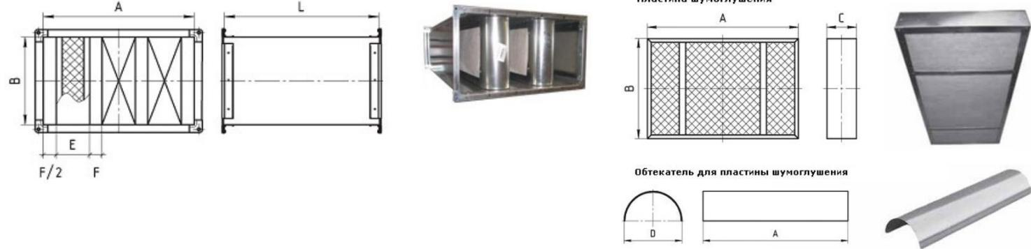
В шумоглушитель пластичатый ГП входят: корпус шумоглушителя, пластины шумоглушения, обтекатель на каждую пластину.
