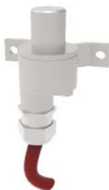
Компактное исполнение терморегулятора. Терморегулятор поставляется в комплекте с кабелем для подключения к сети. Длина кабеля определяется при заказе на основе опросного листа/кода заказа (базовая длина кабеля составляет 1,0 м). По заказу терморегулятор может быть укомплектован клеммной коробкой для подключения к обогревателю и силовому кабелю. Данное исполнение возможно только с маркировкой взрывозащиты 1ExmbIICT6GbX.
