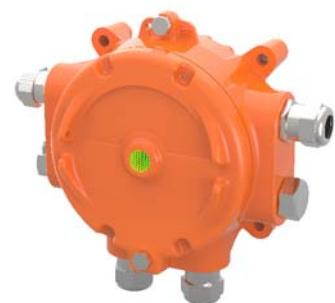
Терморегулятор РИЗУР-ТБ-ЦСУ разрабатывался специально для управления нагревательными элементами большой мощности (до 5 кВт), в том числе и саморегулирующимися греющими кабелями. Терморегулятор выдерживает холодные пусковые нагрузки, превышающие номинальную мощность в 10 раз.
