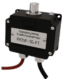
Интегральное исполнение терморегулятора. В данном исполнении терморегулятор располагается в/на металлической оболочке (в зависимости от исполнения по взрывозащите). Данная оболочка также выполняет функцию соединительной коробки, то есть внутри оболочки расположен клеммный блок, а на оболочке размещены взрывозащищенные кабельные вводы для силового кабеля.
