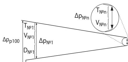
При закрытии регулирующего клапана перепад давлений может увеличиться вплоть до величины  $\Delta P$  № 1, степень регулирования при этом значительно снижается и расход теплоносителя по остальным веткам системы увеличивается не-пропорционально.
