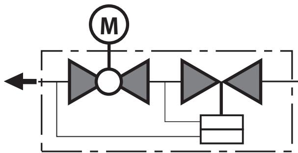
**Ограничение расхода** Несмотря на применение электропривода, кран может быть настроен с помощью ограничителя расхода таким образом, чтобы через теплообменник в любом случае проходило некоторое количество теплоносителя.
