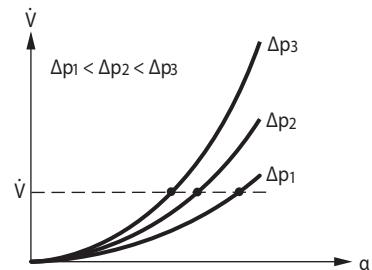
Требуемое текущее значение расхода  $V$  при изменении перепада давления на клапане  $\Delta p$  обеспечивается изменением угла поворота  $\alpha$ .
