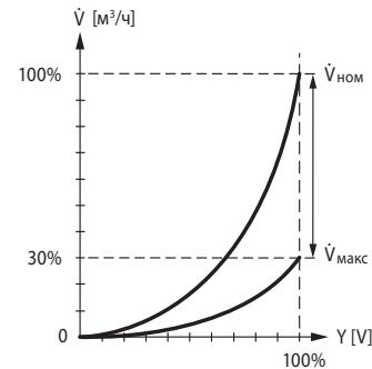
**Компенсация при низком расходе** При низкой скорости потока через открытый клапан, измеритель не может регистрировать его в пределах заданной погрешности. В таком случае расход учитывается электронным способом
