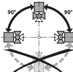
**Установка на обратную воду** Рекомендуется установка на обратную воду.
