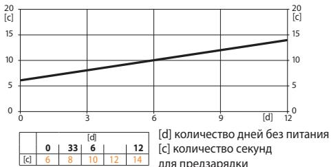
**Время предварительной зарядки.** В случае привода со встроенным конденсатором требуется определенное время для зарядки конденсатора. Это время для зарядки конденсатора до уровня, позволяющего приводу работать. В этом случае зарядки хватит на то, чтобы при отключении питания привод занял охранное положение.
