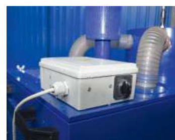
Пульт управления с реверсивным выключателем
