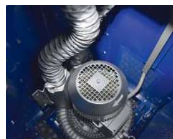
Вентиляторная камера с вихревым вентилятором
