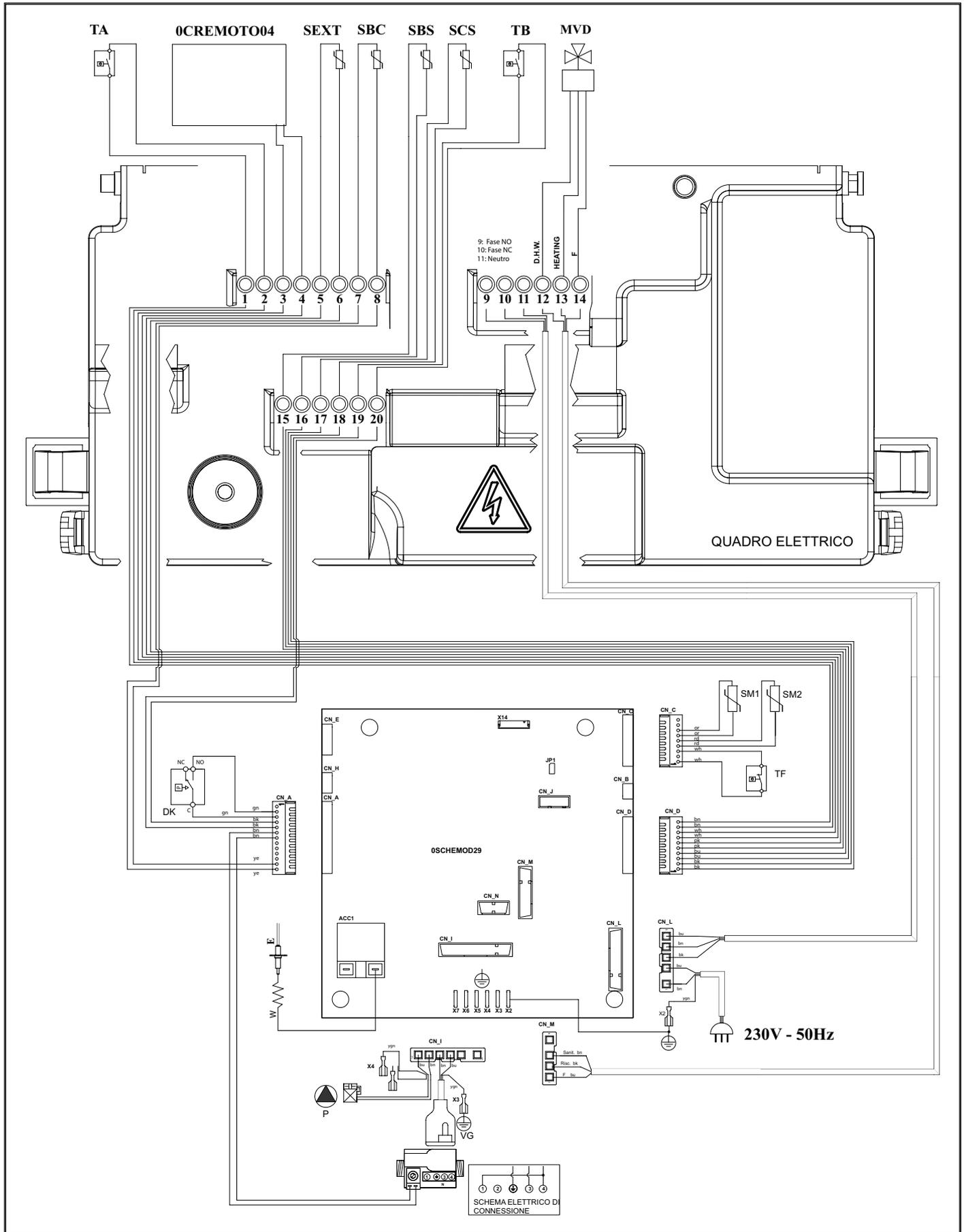
Рис. 25 Электрическая схема RTN
