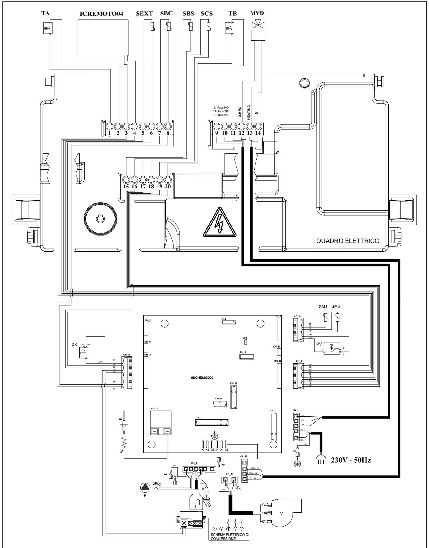
Рис. 23 Электрическая схема RTFS
