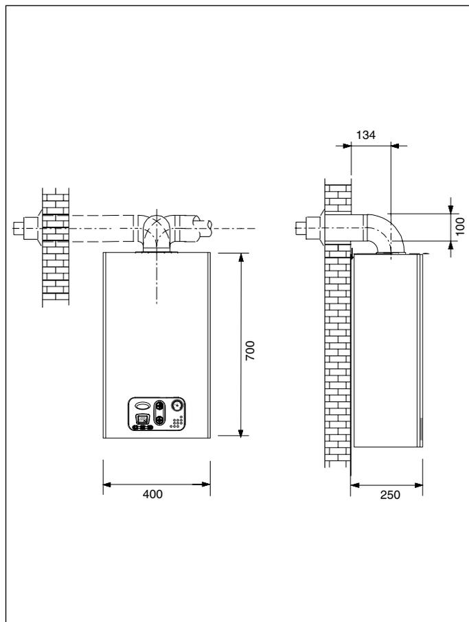
Рис. 13 Размеры для подсоединения к коаксиальному трубопроводу забора воздуха/отвода дымовых газов
