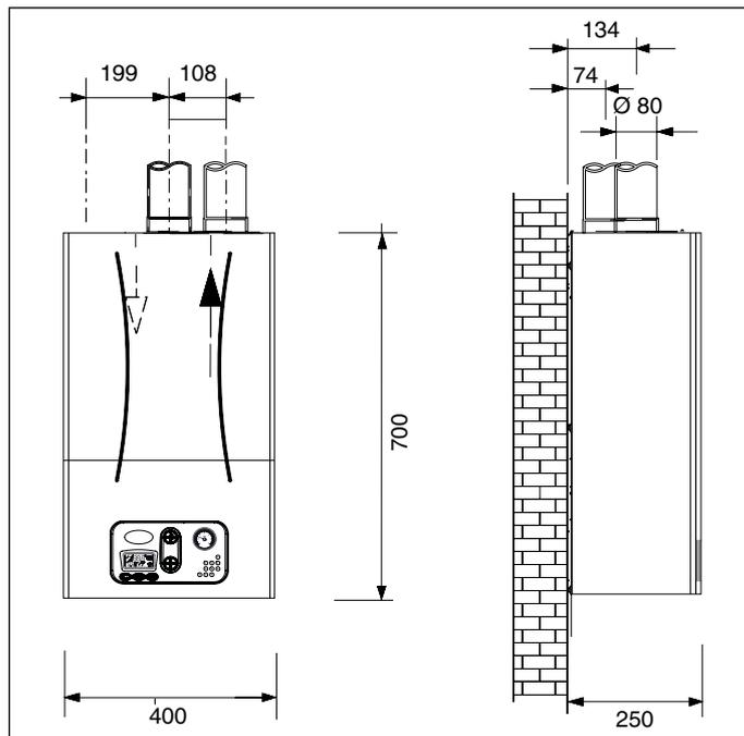
Рис. 15 Размеры для подсоединения отдельных труб воздухоподачи/дымоотвода
