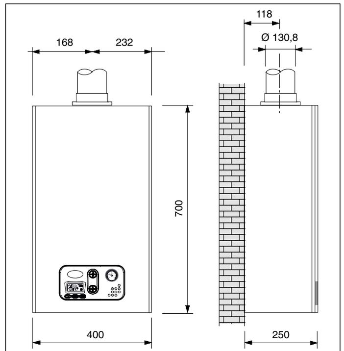
Рис. 11 Габаритные размеры для подключения к дымоходу модели с естественной тягой
