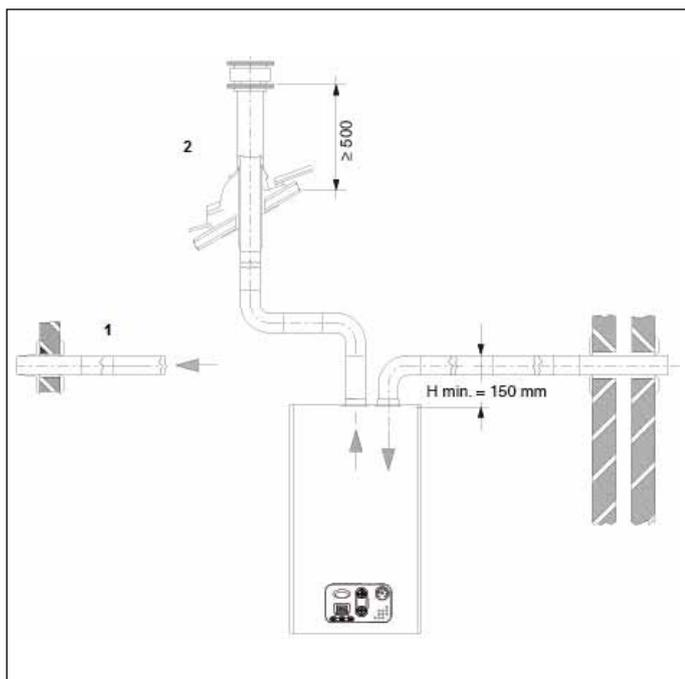
Рис. 16 Примеры системы воздухозабора / дымоотвода
