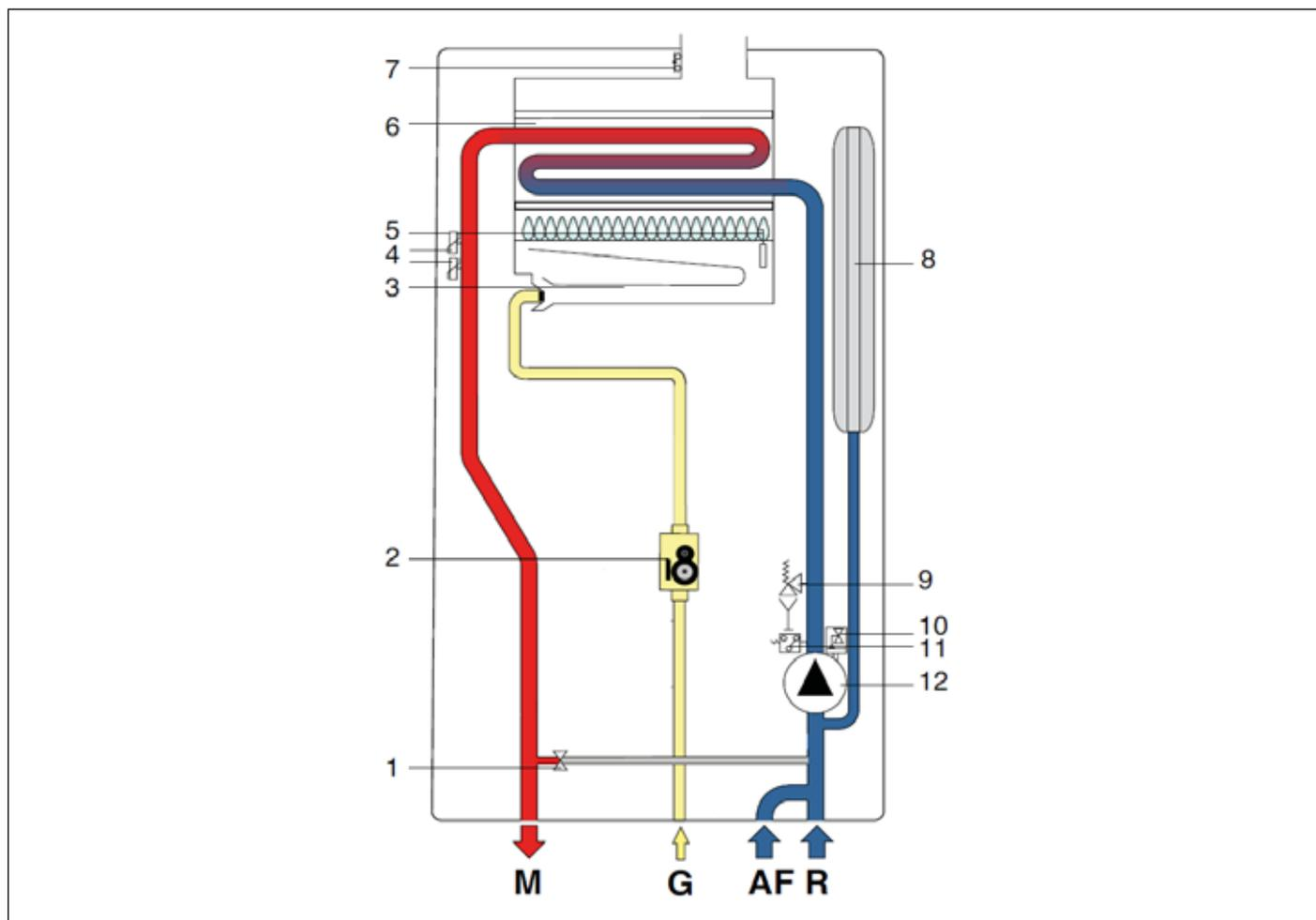
Рис. 8 Гидравлическая схема котла (мод. RTN)
