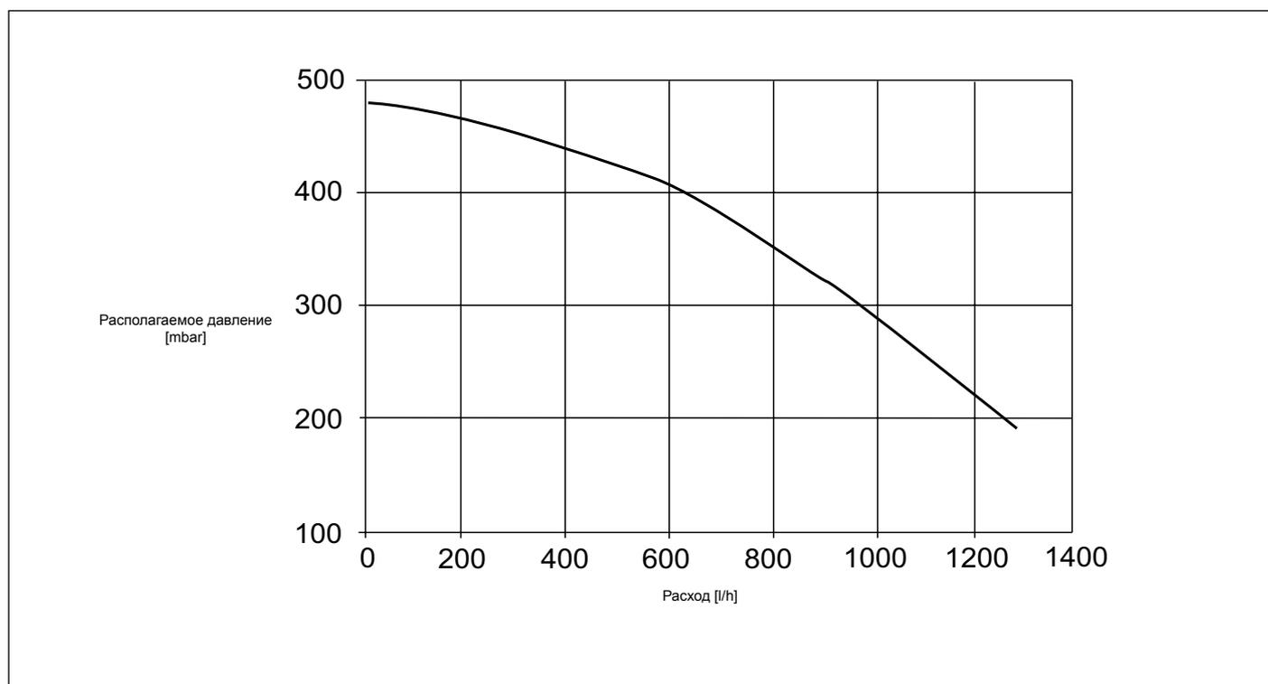
Рис. 21 Потеря давления циркуляционного насоса
