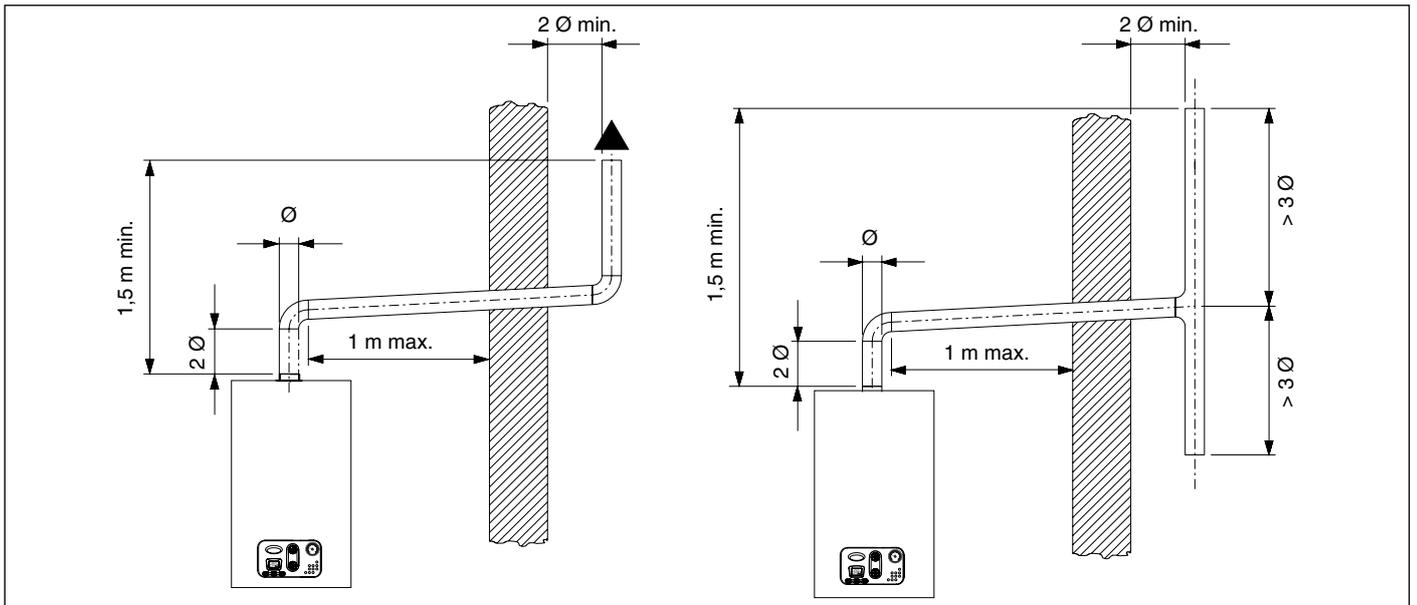
Рис. 10 Подсоединение к дымоходу котлов с открытой камерой сгорания
