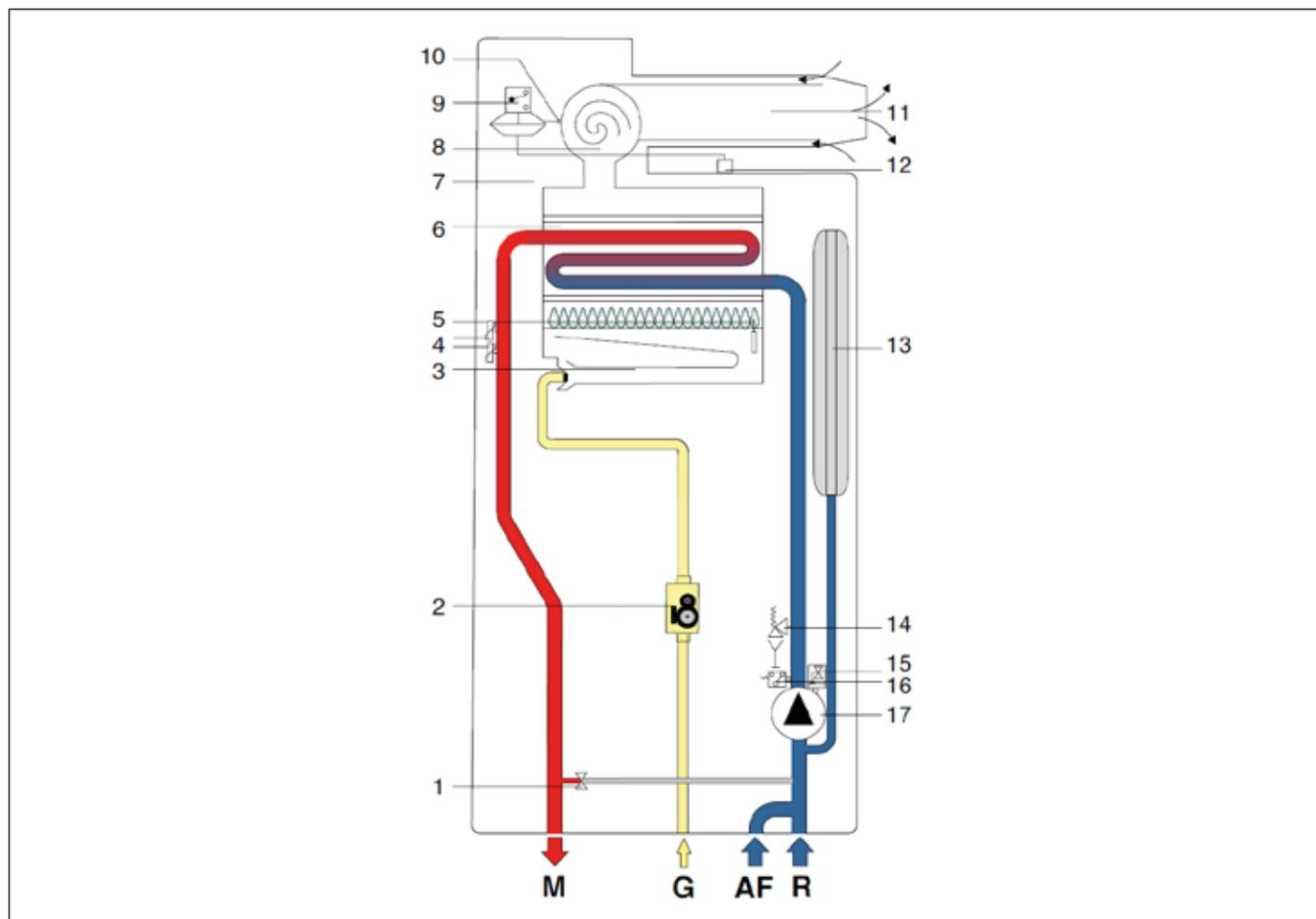
Рис. 7 Гидравлическая схема котла (мод. RTFS)
