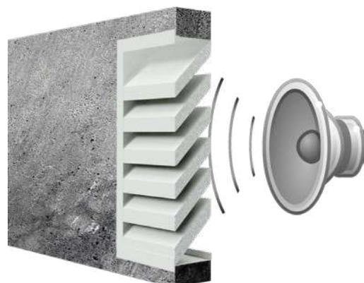
Чтобы исключить сопутствующий шум и большой перепад давления, расход воздуха через решетку должен контролироваться. Скорость воздуха (макс. 10м/с) получаем путем деления расхода воздуха на ее нетто-площадь сечения. Нетто площадь считается путем умножения общей брутто-площади сечения решетки на коэффициент, полученный из диаграммы:
