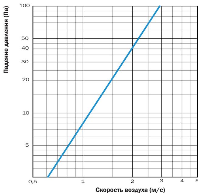
Диаграмма показывает падение давления CELdek 7060-15 в намоченном состоянии. В сухом состоянии, падение давления <10% меньше. Поэтому при сравнении сухих панелей с мокрыми, есть минимальная потеря давления потока воздуха.
