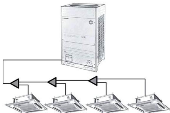
Несмотря на широкие функциональные возможности, конфигурация системы достаточно проста: это наружные и внутренние блоки, соединенные трубопроводом и кабелями коммуникации. В наружных блоках размещены компрессоры, конденсаторы, расширительные вентили, платы управления. Внутренние блоки обеспечивают кондиционирование воздуха в помещениях (охлаждение, нагрев, осушку и очистку от пыли).
