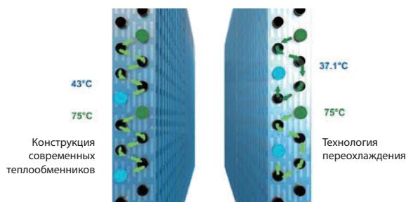
Новая δ-образная конфигурация расположения трубок теплообменника позволяет достичь брадусного переохлаждения хладоносителя. При наружной температуре 35 °C хладагент охлаждается до 37.1 °C. Скорость теплообмена в конденсаторе повысилась, снизилось сопротивление в системе, выросла производительность. Благодаря примененной технологии стало возможно увеличение общей длины трубопровода до 1000 м. В то же время конструкция теплообменного контура наружного блока стала проще, масса меньше.
