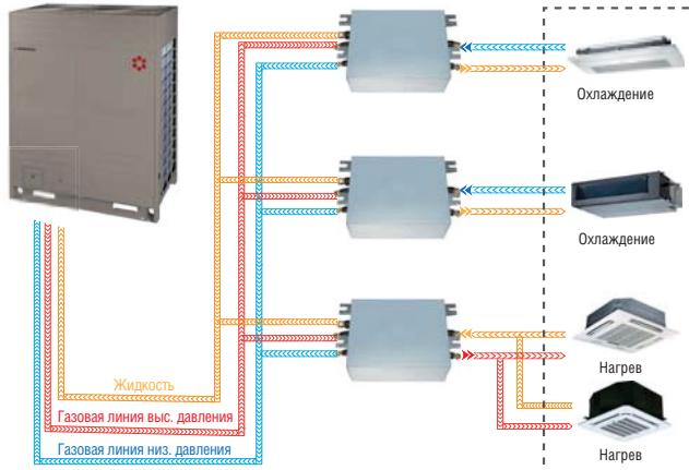
❖ НОВАЯ КОНСТРУКЦИЯ ТЕПЛООБМЕННИКА НАРУЖНОГО БЛОКА С ДВУМЯ НЕЗАВИСИМЫМИ ПАРАЛЛЕЛЬНЫМИ ТЕПЛООБМЕННИЧЕСКИМИ КОНТУРАМИ, ВЕНТИЛЯТОРАМИ И ЭЛЕКТРОННО-РАСШИРИТЕЛЬНЫМИ ВЕНТИЛЯМИ.
