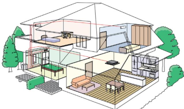
■ К наружному блоку мультисистемы K2(3,4,5)MRC можно подключить до пяти внутренних блоков настенного типа различных мощностей.
