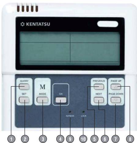
Этот центральный пульт управления может осуществлять централизованное управление и запрос данных с наружных блоков. Один центральный пульт можно подключить к максимум 32 наружным блокам системы DX PRO через сетевой интерфейсный модуль. Данный пульт значительно упрощает сервисное обслуживание.
