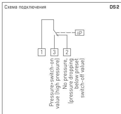
Данные, касающиеся давления срабатывания, относятся к вертикальному монтажу; рекомендуется монтировать реле патрубком вниз. При вертикальном монтаже с подводом давления сверху порог срабатывания повышается на 0,2 мбар.
