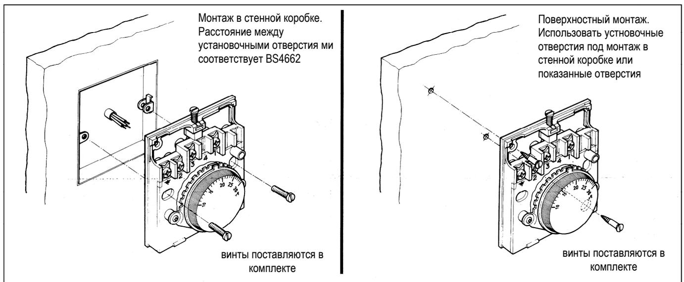
Рис. 2. Монтаж термостата
