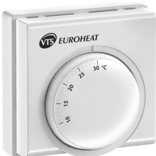
Термостат TR 010 предназначен для автоматического (ВКЛ/ВЫКЛ) управления газовыми котлами, циркуляционными насосами и зонными клапанами в системах отопления, охлаждения или отопления/охлаждения, в которых требуется однополюсное или двухполюсное переключение до 10 А (резистивная нагрузка) или 3 А (индуктивная нагрузка).
