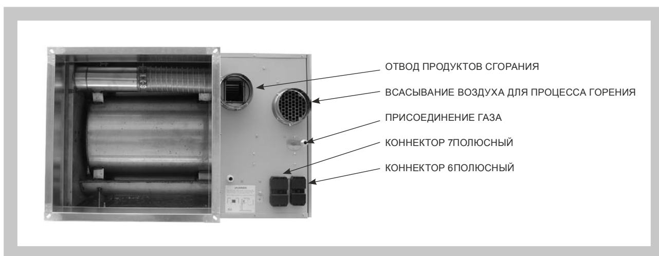
Изобр. 6. Вид задней панели нагревателя Monzun Euroklim
