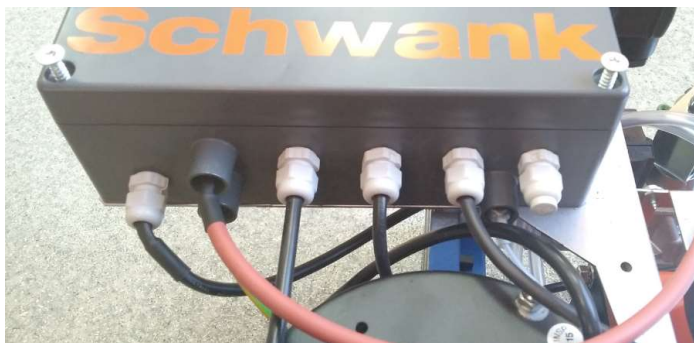
Рисунок 4.4.1 Внешний вид устройства розжига и контроля горения
