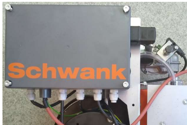
Рисунок 4.4.1 Внешний вид устройства розжига и контроля горения
