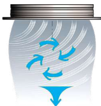
Вертикальная коническая закрученная струя (В)
