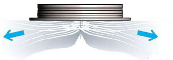
Горизонтальная настилающаяся закрученная струя (Г)
