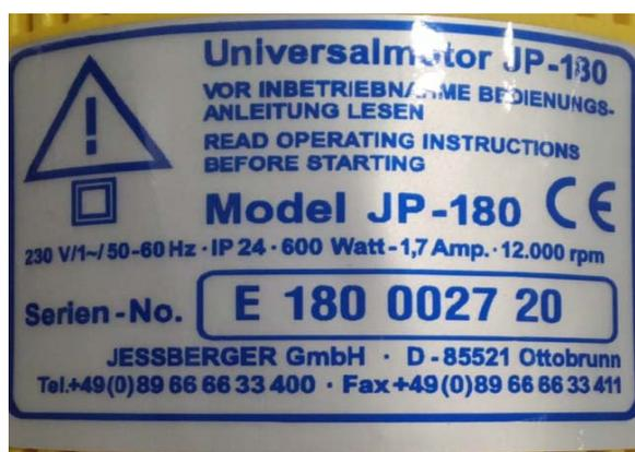
Рисунок 1. Маркировка насоса JP.
