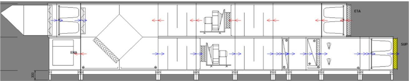
Наружная установка с пластинчатым рекуператором, водяным обогревом и охлаждением, увлажнением, двухступенчатой фильтрацией и шумоглушением на притоке и вытяжке.
