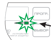
Сигнальный светодиод автоматического режима работы
