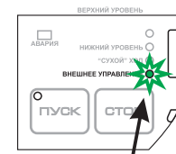
Сигнальный светодиод входа “Внешнее управление”
