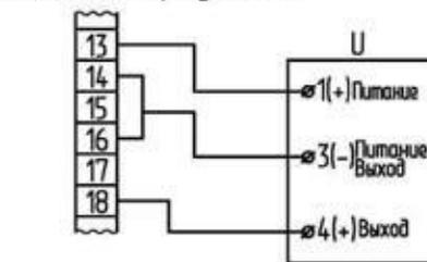
Рисунок Б.5-Схема механизма МЭО-92К с БСПТ-10М;
