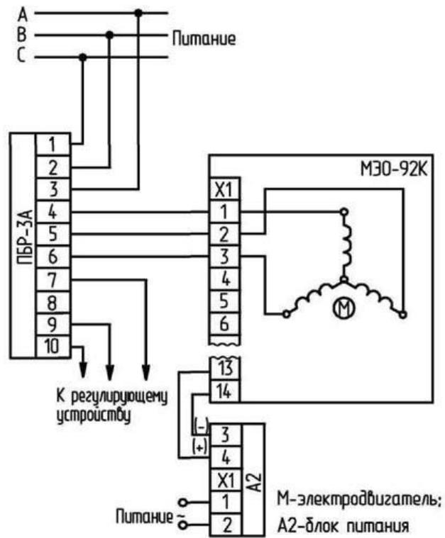
Рисунок В.1- Схема бесконтактного управления
