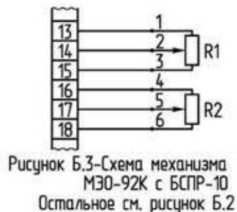
Рисунок Б.3-Схема механизма МЭО-92К с БСПР-10
