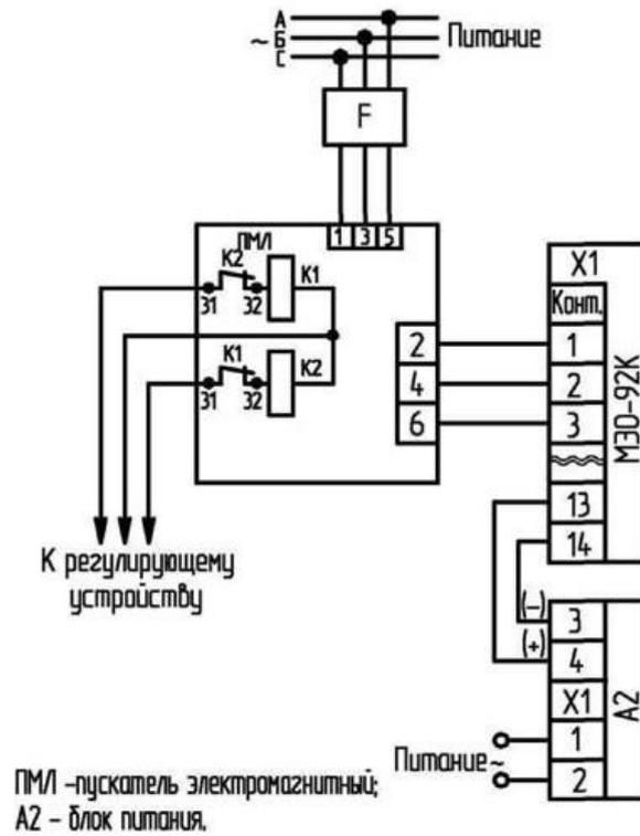
Рисунок В.2- Схема контактного управления
