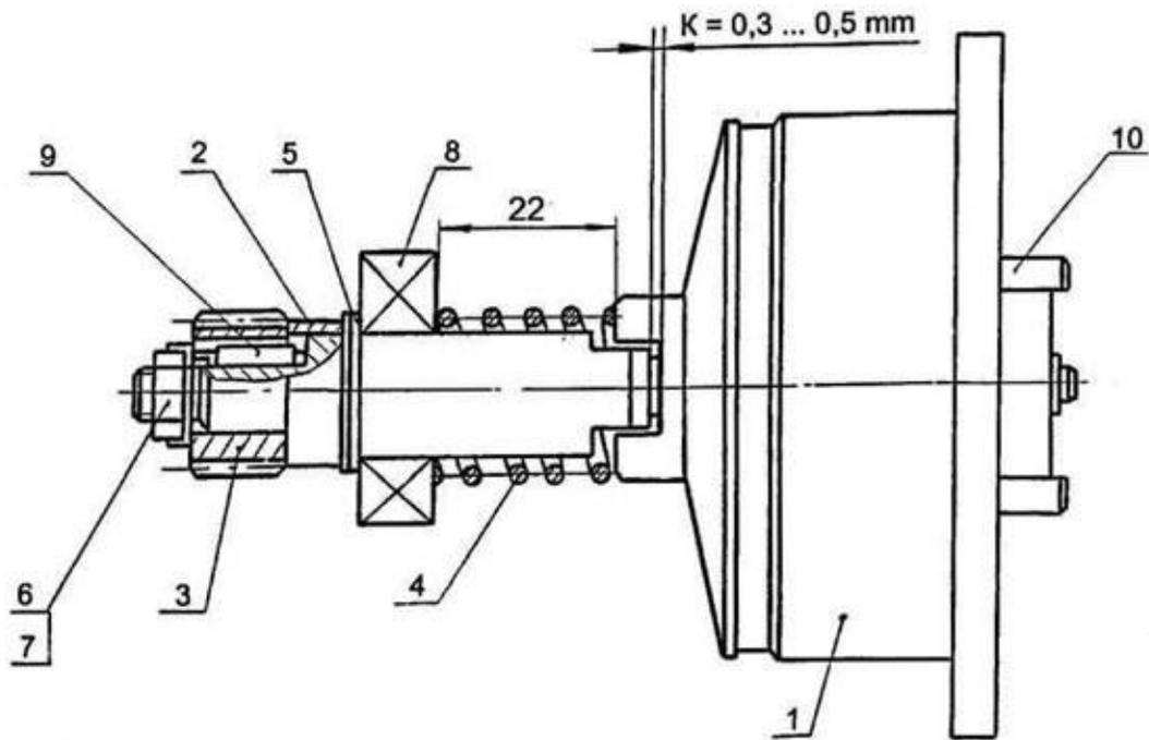
1 - тормоз; 2 - втулка; 3 - шестерня; 4 - пружина; 5 - кольцо; 6 - шайба стопорная; 7 - гайка; 8 - подшипник; 9 - шпонка; 10 - полумуфта.
