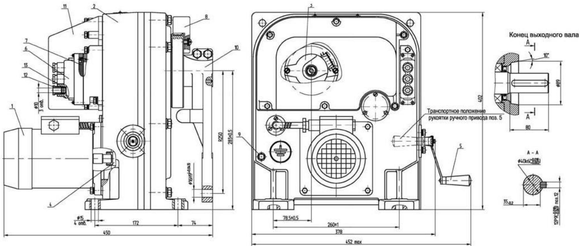
1-привод; 2-редуктор; 3-блок сигнализации положения; 4-тормоз; 5-привод ручной; 6-розетка; 7-вилка; 8-упор; 9-болт заземления; 10-рычаг; 11-крышка; 12-гайка; 13-кольцо уплотнительное.
