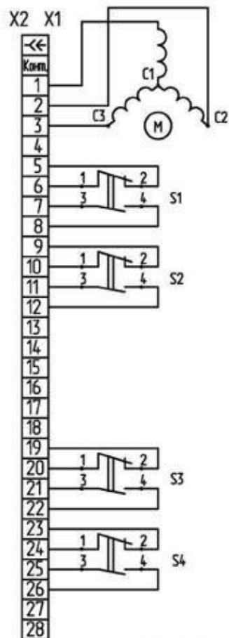
Рисунок Б.2-Схема механизма МЭО-92К с БКВ;
