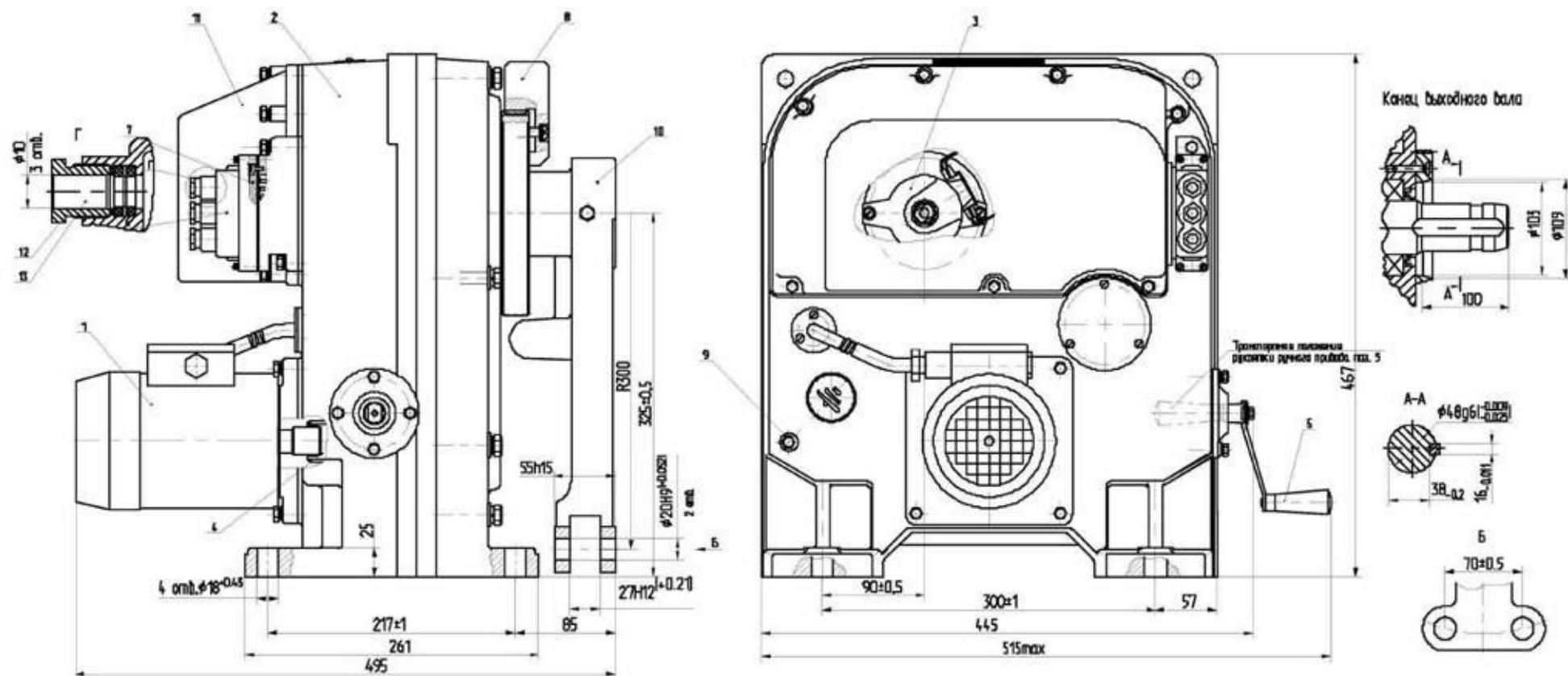
1 – привод; 2 - редуктор; 3 - блок сигнализации положения; 4 - тормоз; 5 - ручной привод; 6 - розетка; 7 – вилка; 8 – упор; 9 - болт заземления; 10 - рычаг; 11 - крышка; 12 - гайка; 13 - кольцо уплотнительное.
