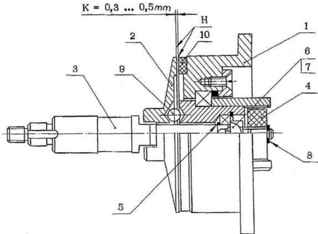
1 - корпус; 2 - диск; 3 - вал; 4 - сухарь; 5 - кольцо; 6 - шайба стопорная; 7 - гайка; 8 - шайба быстросъемная; 9 - шарик; 10 - кольцо фрикционное.
