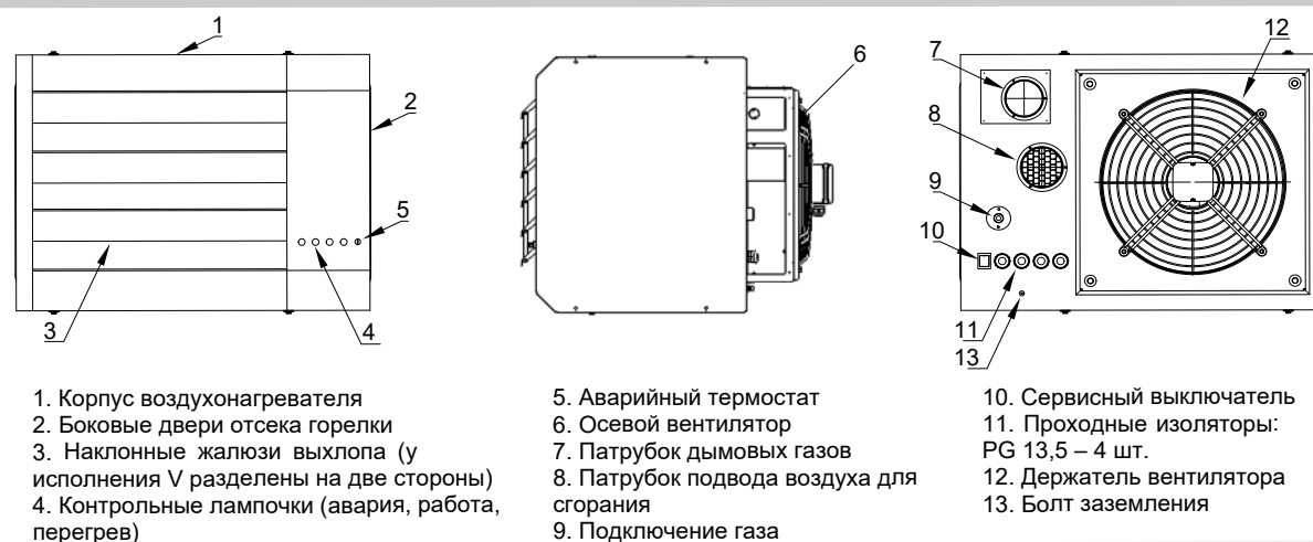
Рис. 4 Основные части воздухонагревателя MONZUN, исполнение Z и V
