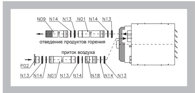
Рис. 3. Отведение продуктов горения и приток воздуха для процесса горения через стену здания при помощи гибкой трубы с концевой фасадной частью и решеткой всасывания
