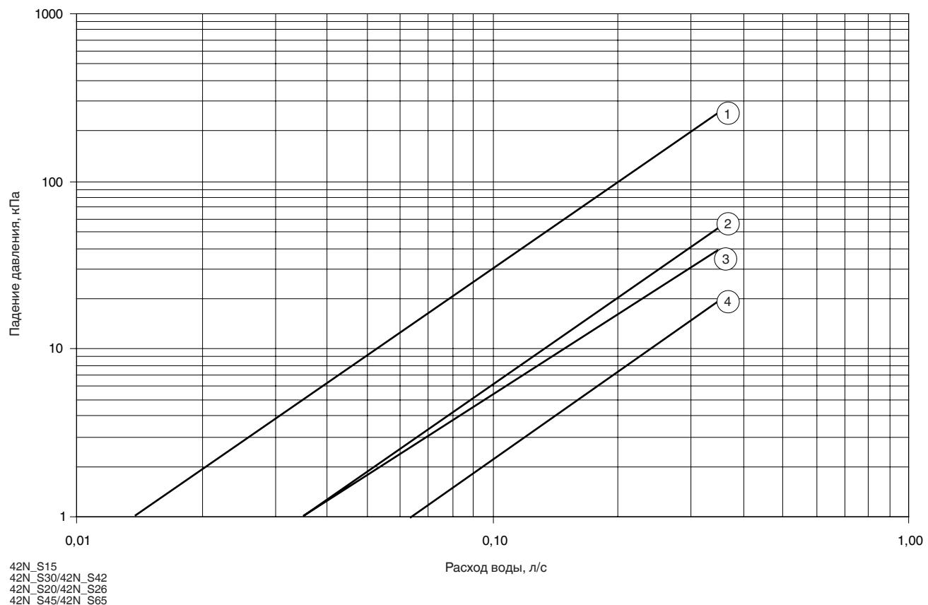
Режимы обогрева (температура поступающей воды = 50°C)
