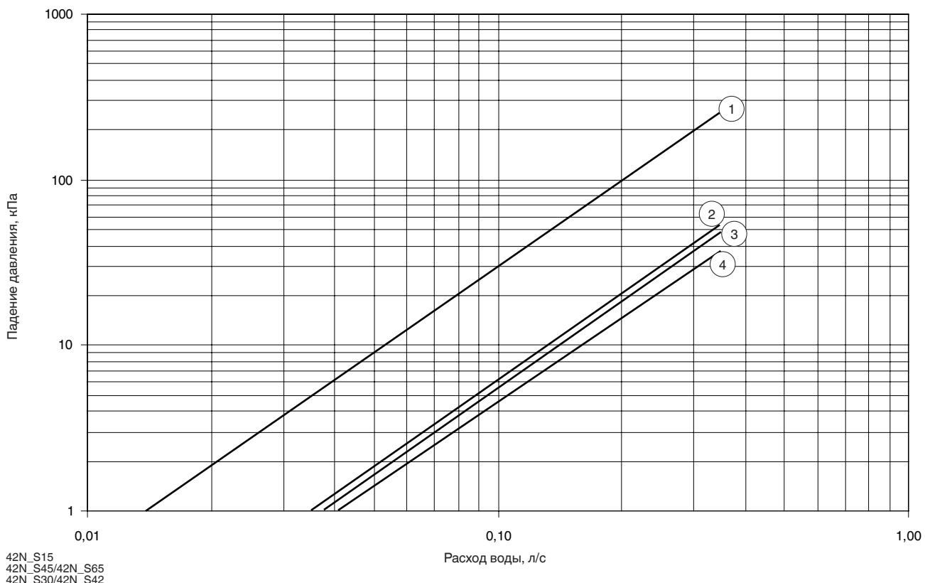
Режимы обогрева (температура поступающей воды = 70°C)
