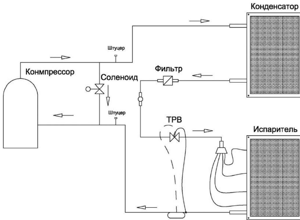
**Гидравлическая схема осушителя**
