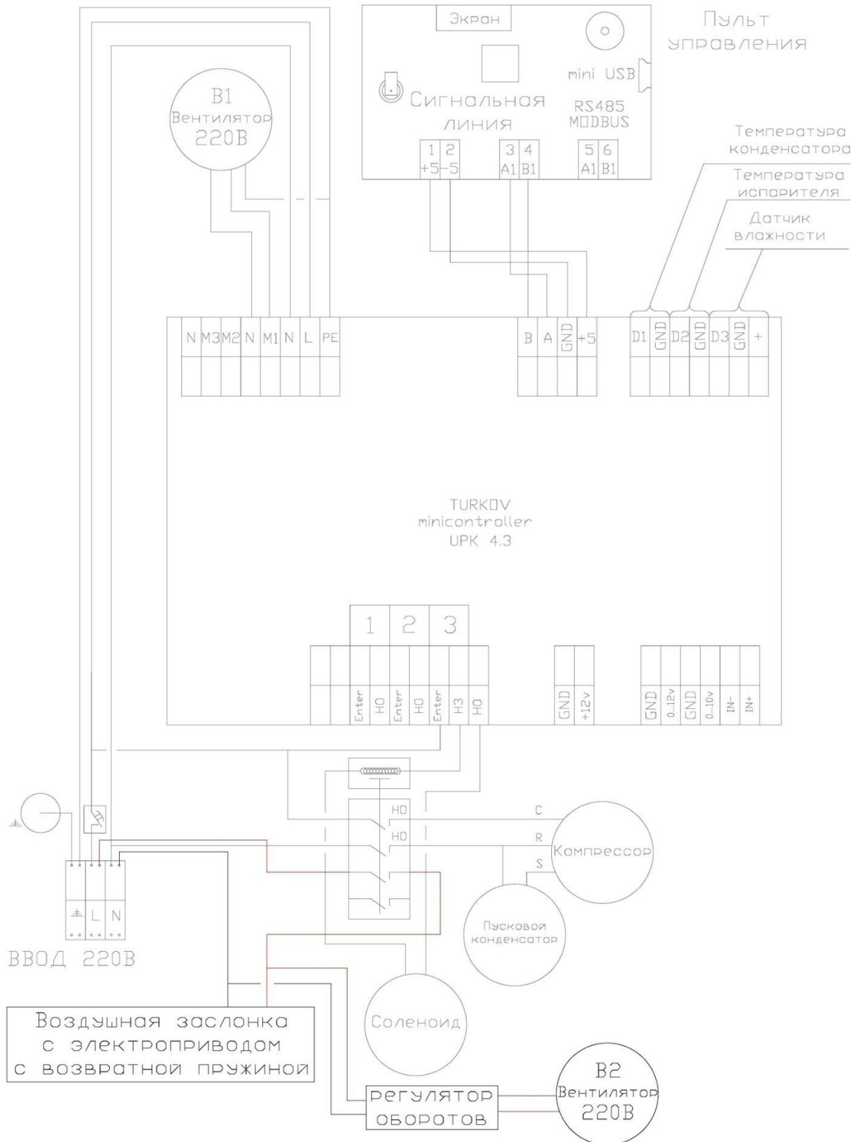
**Схема Электрическая схема осушителя с подмесом свежего воздуха
