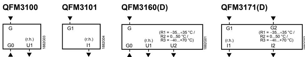
G, G0 Рабочее напряжение AC 24 В (SELV) или DC 13.5...35 В
