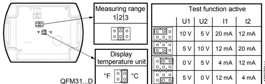
Элементы настройки находится внутри корпуса. Элементы настройки состоят из 6 пинов и переключки. Они используется для настройки требуемого диапазона измерений и для активации функции проверки работоспособности. Модели с LCD дисплеем имеют второй элемент настройки с 4 пинами и переключкой.
