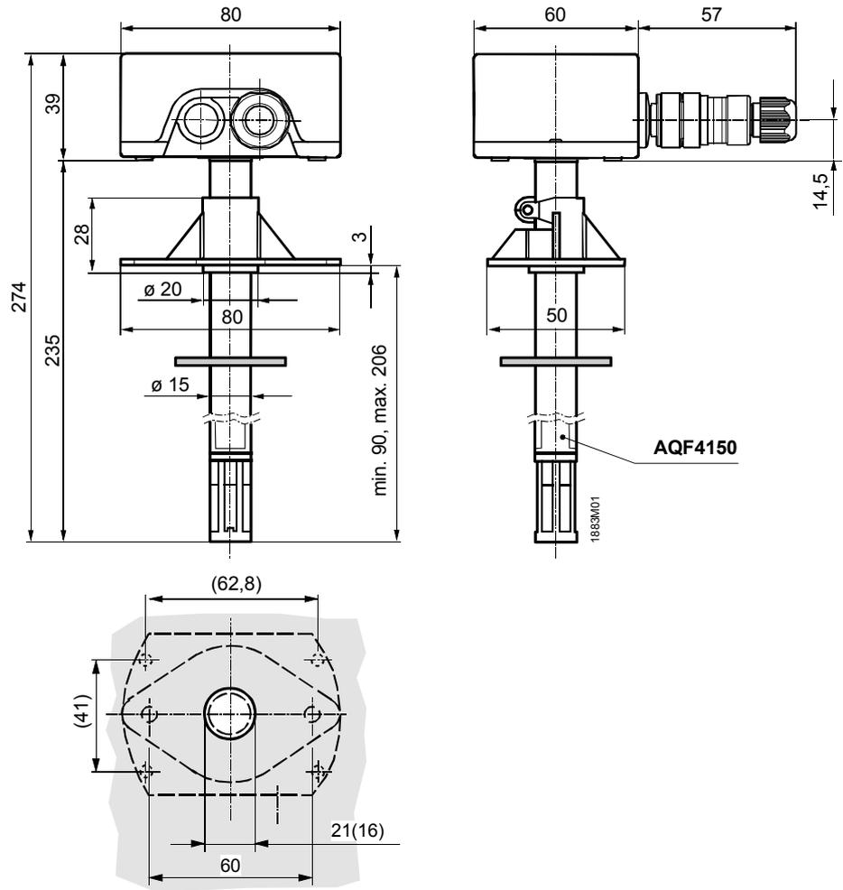
Схема сверления (без) монтажного фланца
