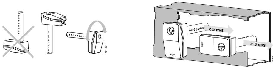
Направление установки зависит от скорости потока воздуха в трубопроводе: если она меньше 5 м/с, отверстия в стержне должны быть направлены вдоль воздушного потока; если больше 5 м/с, то отверстия располагаются перпендикулярно направлению воздушного потока (см. рисунок сверху).
