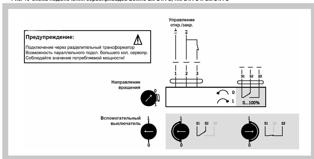
Рис. 10 Схема подключения сервоприводов Belimo LM 24A-S, NM 24A-S и SM 24A-S
