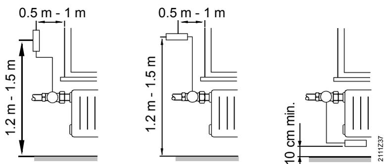
При монтаже на плохо изолированные внешние стены следует проложить термоизоляционный слой.
