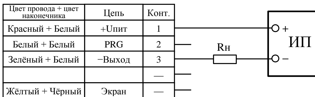
Рисунок В.3 — Соответствие цепей выводов разъёма преобразователей с кодами исполнений 14 и 15 по таблице А.10
