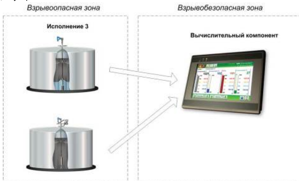
Рисунок Б.3. Общее устройство системы исполнения 3
