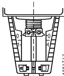
Цилиндр с полностью задвинутым коннектором штока клапана
