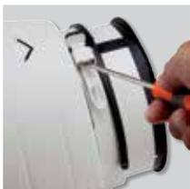
При помощи отвертки, ослабьте защелку.
