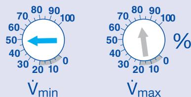
Значение постоянного расхода может быть установлено при помощи потенциометра  $\dot{V}_{min}$ . Значения потенциометра  $\dot{V}_{max}$  не учитываются.
