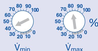
При отгрузке изделия потенциометр  $\dot{V}_{min}$  устанавливается в положение 40 %, а  $\dot{V}_{max}$  – в положение 80 %.
