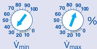
Требуемый расход воздуха устанавливается заказчиком. При установке  $\dot{V}_{min}$  больше, чем  $\dot{V}_{max}$ , значение  $\dot{V}_{min}$  принимается за постоянный расход, даже при подаче сигнала на изменение расхода.
