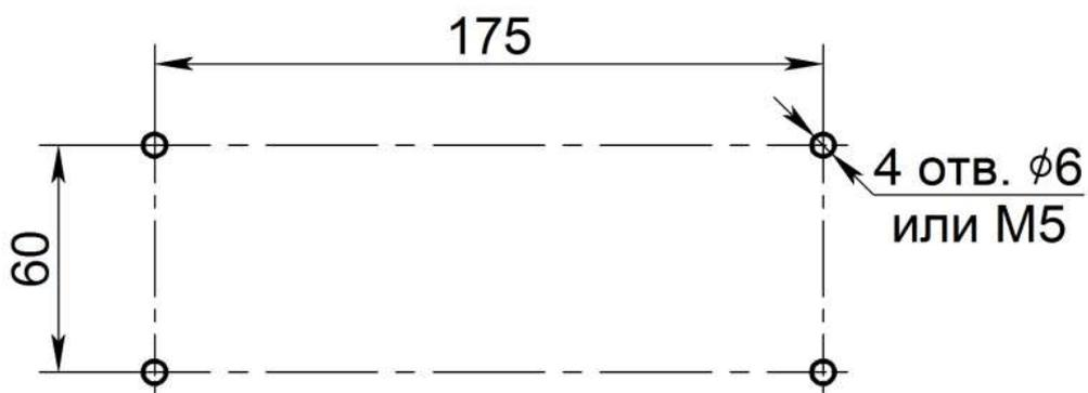
Рисунок Б.1 – Габаритные и установочные размеры ВП
