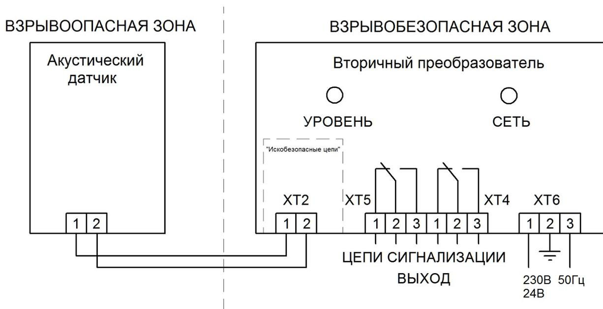
Рисунок В.2 – Схема электрическая подключения регулятора УЗР-1И
