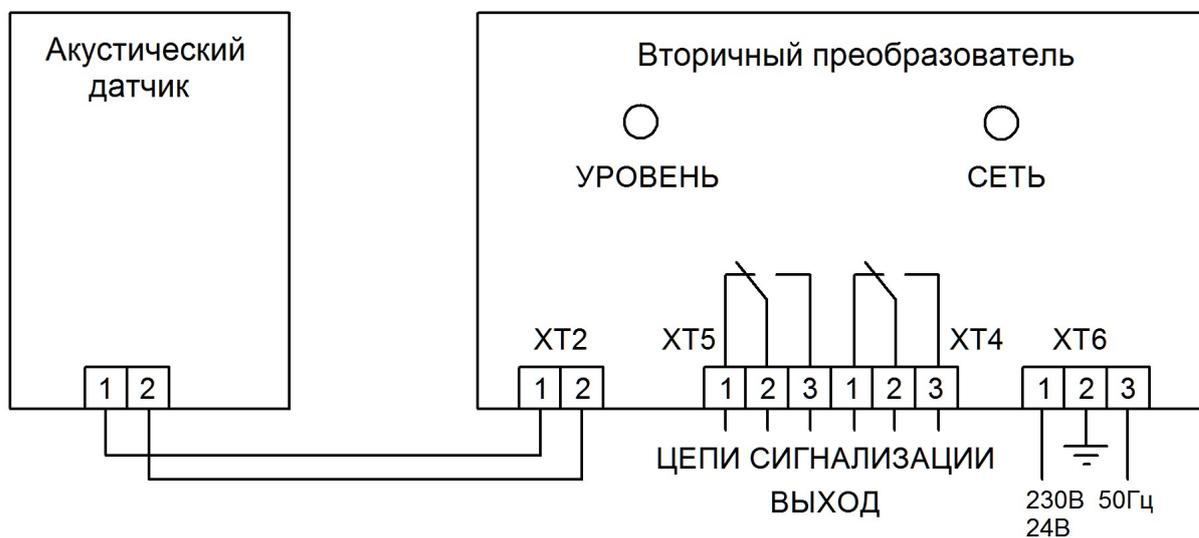
Рисунок В.1 – Схема электрическая подключения регулятора УЗР-1
