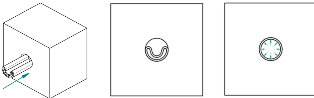
Рис. 6 Установка теплоизоляции в канал трубы
