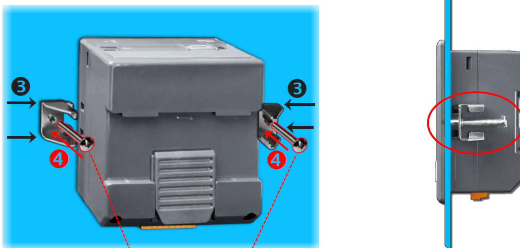
Рисунок 7. Крепление терминала к задней крышке панели (щита).
