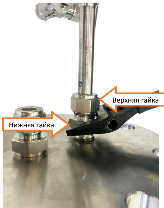
Рисунок 10 – Крепление на резервуаре
