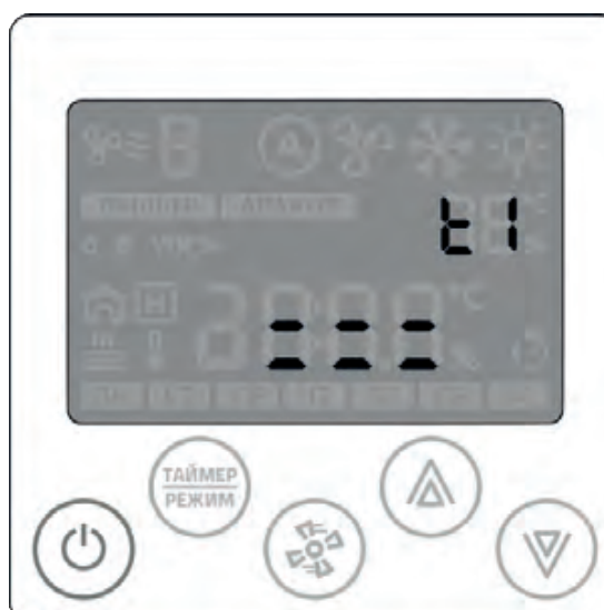
Случай неопределенного состояния таймера: мигает поле с прочерками. Нажмите стрелку «Вверх» или «Вниз»
