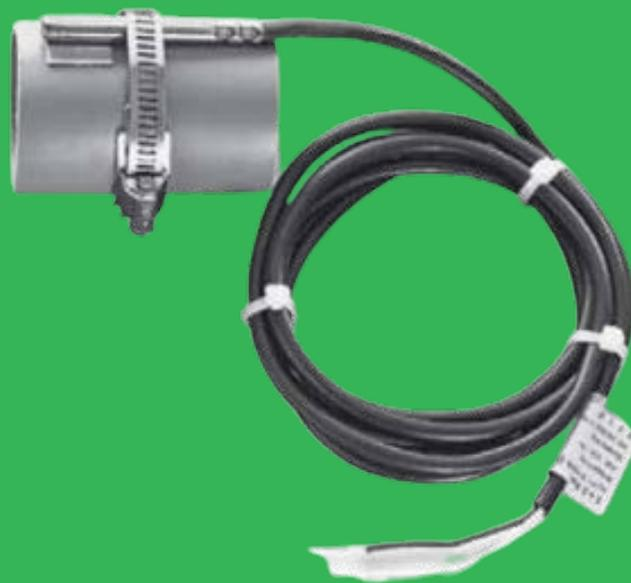
Контактный датчик температуры ALTF1-PT1000 является электрическим термометром для измерения температуры поверхности твердых тел через контактную площадку, соприкасающуюся с измеряемой поверхностью. Датчик определяет температуру среды (например, воды), протекающей в трубе, посредством измерения температуры поверхности трубы. Предназначен для измерения температуры трубопроводов, труб (например, горячего и холодного водоснабжения) или отопительных магистралей с целью регулирования степени нагрева.
