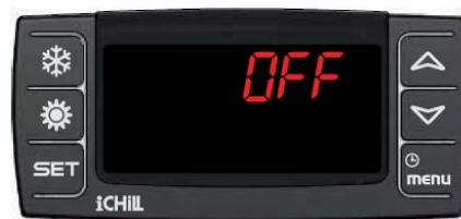
Осушитель выключен внешней блокировкой
