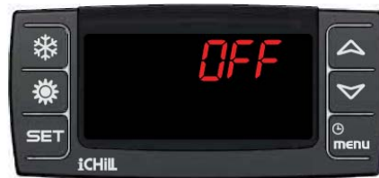
Осушитель выключен внешней блокировкой
