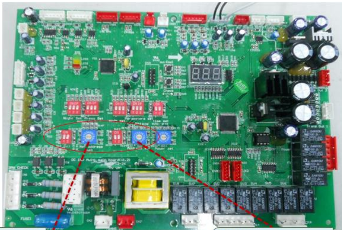
Плата наружного блока
