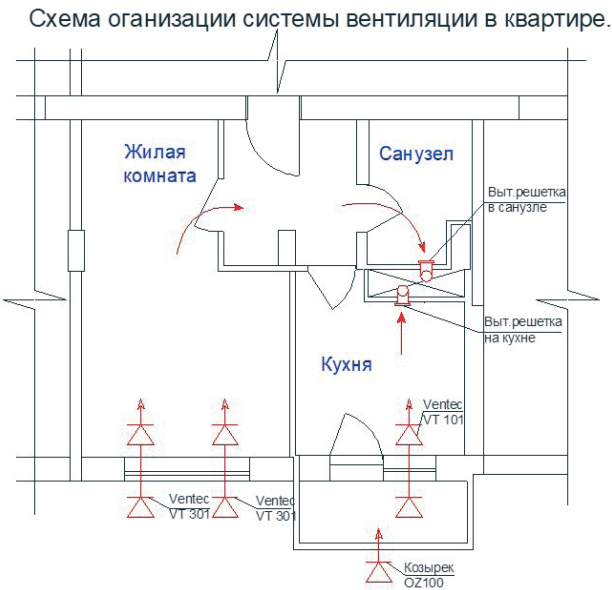
Рис.3.4 Схема установки приточного клапана Ventec серии VT на окне с одной створкой
