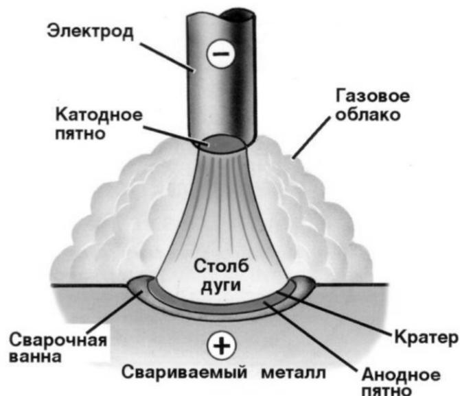
Рис. 1.4. Схема горения сварочной дуги
