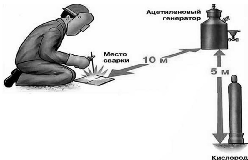
Рис. 4.11. Расстояние от места сварки к баллонам
