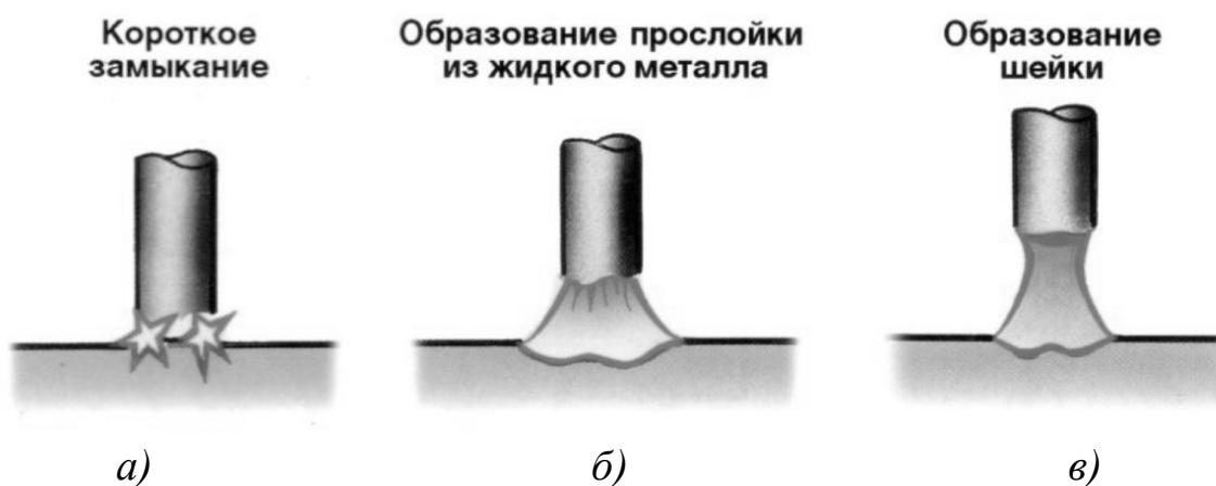
Рис. 1.3. Возбуждение сварочной дуги
