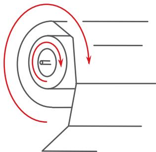
Кондиционер Energolux имеет функцию самоочистки, которую можно активировать с пульта управления. После выключения системы вентилятор внутреннего блока продолжит свою работу некоторое время, чтобы удалить влагу, скопившуюся во внутреннем блоке и, таким образом, предотвратить образование плесени.
