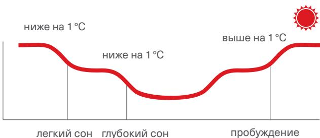
Кондиционер автоматически увеличит (в режиме охлаждения) или уменьшит (в режиме обогрева) температуру на 1°C в час, в первые 2 часа, а через 5 часов выключится. Функция «Комфортный сон» помогает поддерживать наиболее комфортную температуру и экономит электроэнергию.
