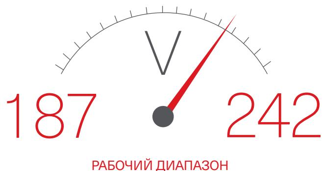
Провалы напряжения – кратковременные понижения напряжения, связанные с резким увеличением нагрузки в сети, из-за включения мощных потребителей (промышленное оборудование, лифты и т. д.), являются наиболее частой неполадкой в электрической сети. По результатам исследований встречается в 87 % случаев проблем, связанных с электропитанием.
