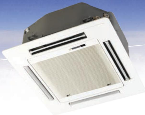
Кассетные фанкойлы COOL предназначены для установки в подвесном потолке домашних и офисных помещений. Автоматические жалюзи, расположенные по краям панели, обеспечивают максимально равномерное распределение воздуха, управление режимами работы жалюзи осуществляется пультом управления. Модельный ряд включает восемь базовых типоразмеров двух- и четырехтрубных фанкойлов холодопроизводительностью от 2 до 8,2 кВт.
