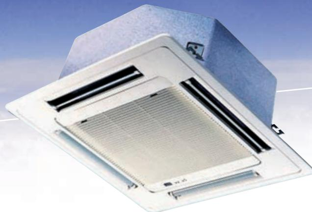
Кассетные фанкойлы COLD предназначены для установки в подвесном потолке домашних и офисных помещений. Автоматические жалюзи, расположенные по краям панели, обеспечивают максимально равномерное распределение воздуха, управление режимами работы жалюзи осуществляется пультом управления.
