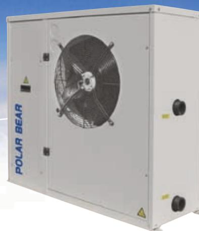
Тепловые насосы SSH предназначены для нагрева воды открытых бассейнов. В тепловых насосах SSH применяется титановый теплообменник, который не корродирует под действием химикатов, содержащихся в воде бассейна. Тепловые насосы оснащены микропроцессорной системой управления, регулирования и оптимизации рабочих параметров. Тепловые насосы готовы к работе после подключения к электропитанию и соединения с контуром воды бассейна, что значительно снижает время на монтажные и пусконаладочные работы.
