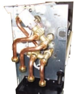
Для управления подачей теплоносителя используются 2-х ходовые и 3-х ходовые вентили (опция). 3-х ходовые вентили позволяют поддерживать постоянную циркуляцию воды в системе даже в закрытом состоянии. Управление вентилями осуществляется с помощью двухпозиционных и трехпозиционных электроприводов, а также электроприводами с пропорциональным управлением 0-10 В.
