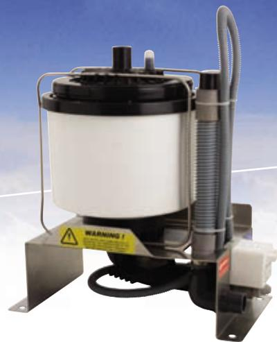
Бескорпусные увлажнители PEGO OEM предназначены для монтажа внутри вентиляционных установок, центральных кондиционеров и прецизионных кондиционеров. Увлажнители могут объединяться в группу до 6 блоков, при этом суммарная производительность достигает 144 кг/час. Контроллер IntoOne, управляющий работой пароувлажнителя, может быть установлен в любом удобном месте, например, в шкафу управления.
