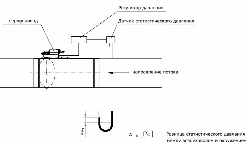
Рис. 5 Регулировка давления в помещении
