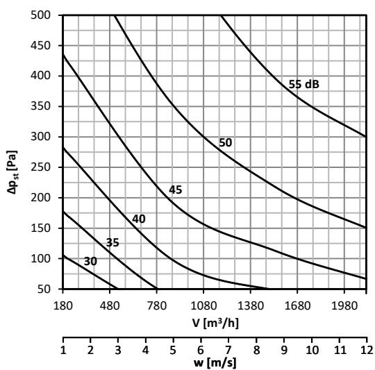
**График 25. Уровень акустической мощности LWA [дБ(А)], излучаемой мимо воздуховод DN280, без изоляции**
