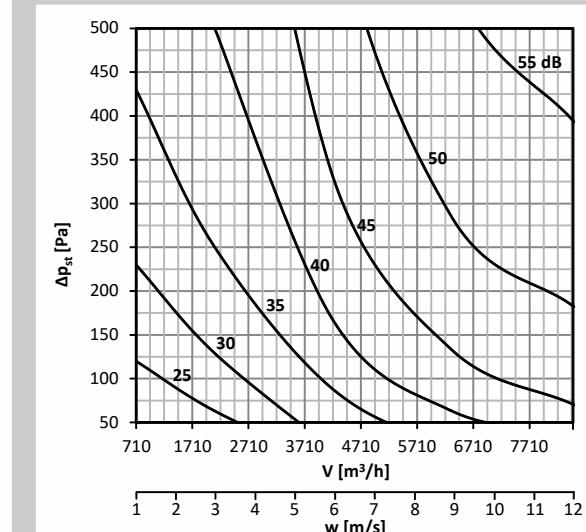
График 45. Уровень акустической мощности Lwa [дБ(А)], излучаемой мимо воздуховод DN630, с изоляцией
