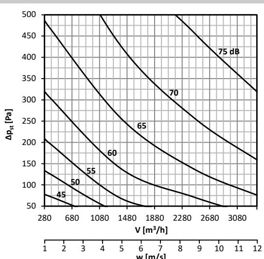
**График 12. Уровень акустической мощности LWA [дБ(А)], выделяемой в воздуховод DN355**
