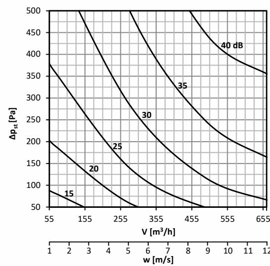
**График 35. Уровень акустической мощности L<sub>WA</sub> [дБ(А)], излучаемой мимо воздуховод DN160, с изоляцией**
