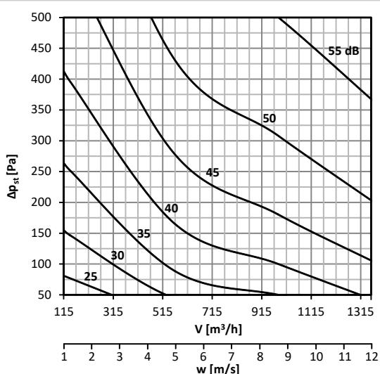
**График 23. Уровень акустической мощности LWA [дБ(А)], излучаемой мимо воздуховод DN225, без изоляции**
