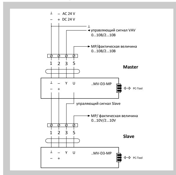
Рис. 9 Сервоприводы LMV-D3-MOD и NMV-D3-MOD
