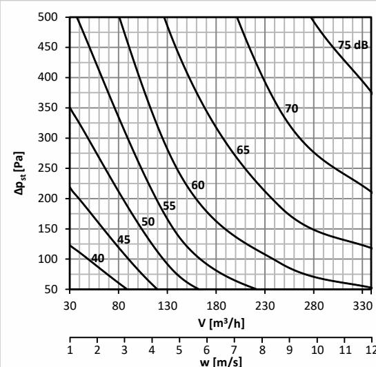
**График 3. Уровень акустической мощности L<sub>WA</sub> [дБ(А)], выделяемой в воздуховод DN125**
