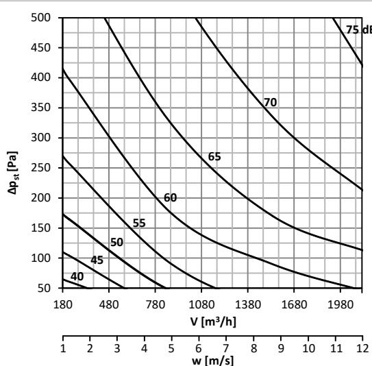
**График 10. Уровень акустической мощности LWA [дБ(А)], выделяемой в воздуховод DN280**
