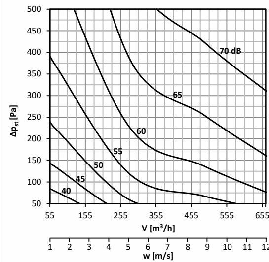
**График 5. Уровень акустической мощности L<sub>WA</sub> [дБ(А)], выделяемой в воздуховод DN160**
