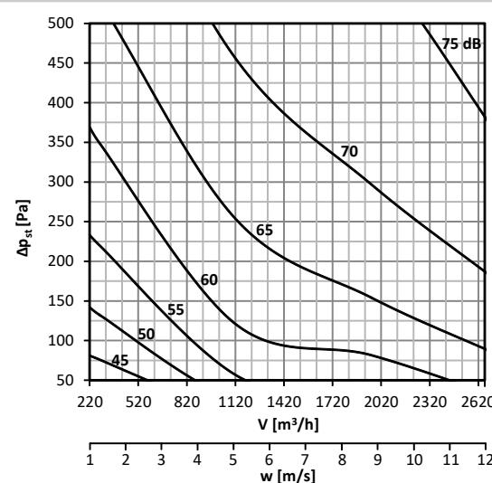
**График 11. Уровень акустической мощности LWA [дБ(А)], выделяемой в воздуховод DN315**
