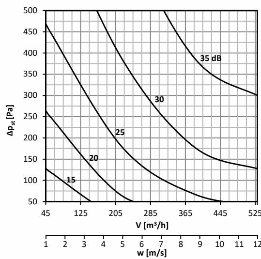
**График 34. Уровень акустической мощности L<sub>WA</sub> [дБ(А)], излучаемой мимо воздуховод DN140, с изоляцией**
