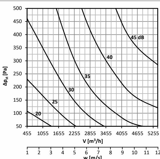
График 44. Уровень акустической мощности Lwa [дБ(А)], излучаемой мимо воздуховод DN500, с изоляцией
