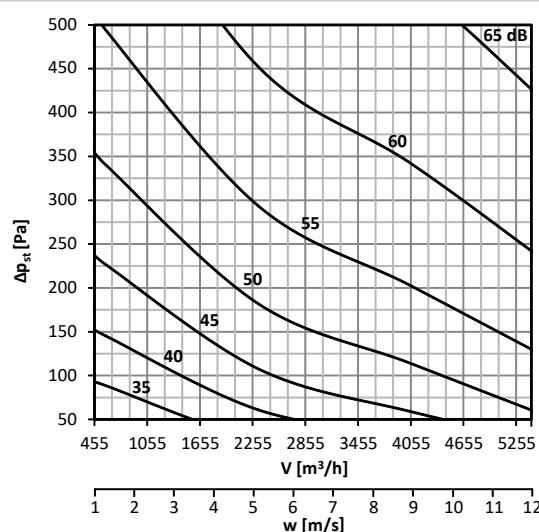
График 29. Уровень акустической мощности L<sub>WA</sub> [дБ(А)], излучаемой мимо воздуховод DN500, без изоляции
