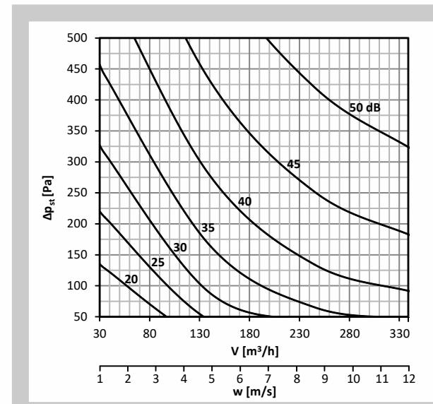
График 18. Уровень акустической мощности LWA [дБ(А)], излучаемой мимо воздуховод DN125, без изоляции
