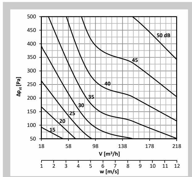
График 17. Уровень акустической мощности LWA [дБ(А)], излучаемой мимо воздуховод DN100, без изоляции
