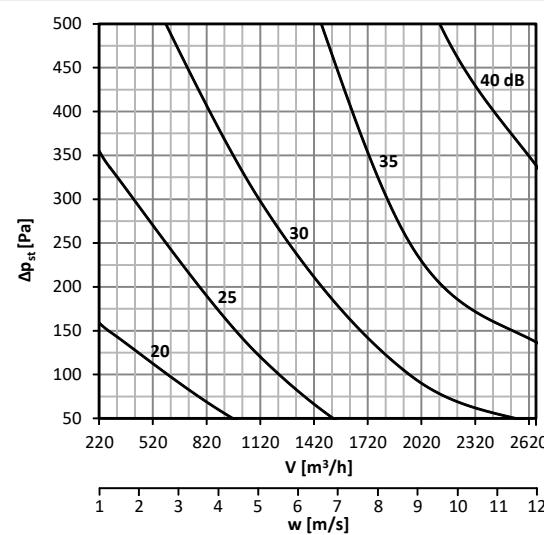
**График 42. Уровень акустической мощности LWA [дБ(А)], излучаемой мимо воздуховод DN355, с изоляцией**
