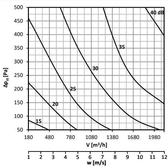
**График 41. Уровень акустической мощности LWA [дБ(А)], излучаемой мимо воздуховод DN315, с изоляцией**
