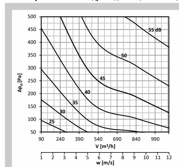
**График 22. Уровень акустической мощности LWA [дБ(А)], излучаемой мимо воздуховод DN200, без изоляции**
