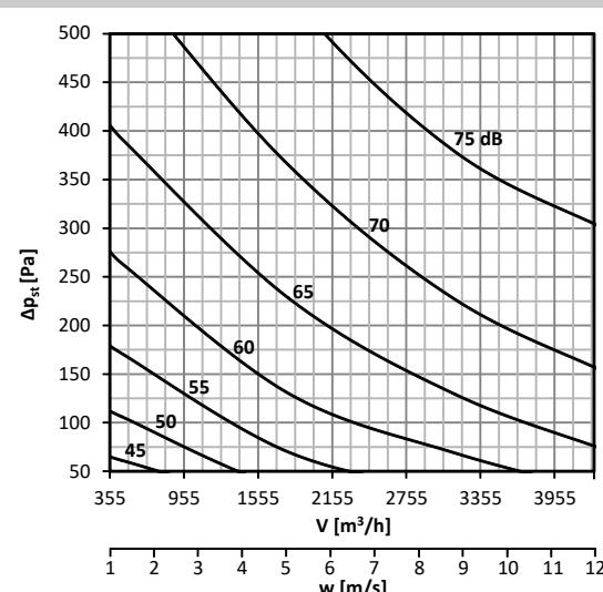
График 13. Уровень акустической мощности  $L_{WA}$  [дБ(А)], выделяемой в воздуховод DN400
