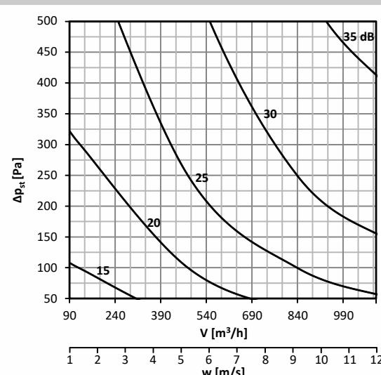
**График 37. Уровень акустической мощности LWA [дБ(А)], излучаемой мимо воздуховод DN200, с изоляцией**
