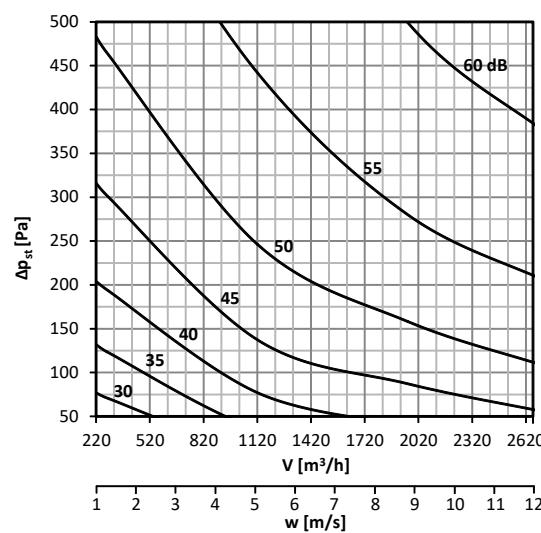
**График 26. Уровень акустической мощности LWA [дБ(А)], излучаемой мимо воздуховод DN315, без изоляции**
