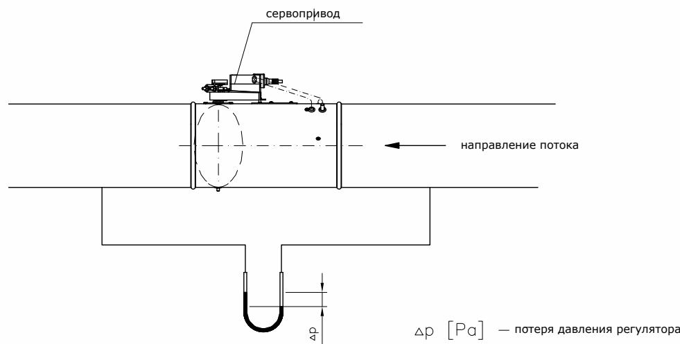
Рис. 4 Регулировка давления в воздуховоде
