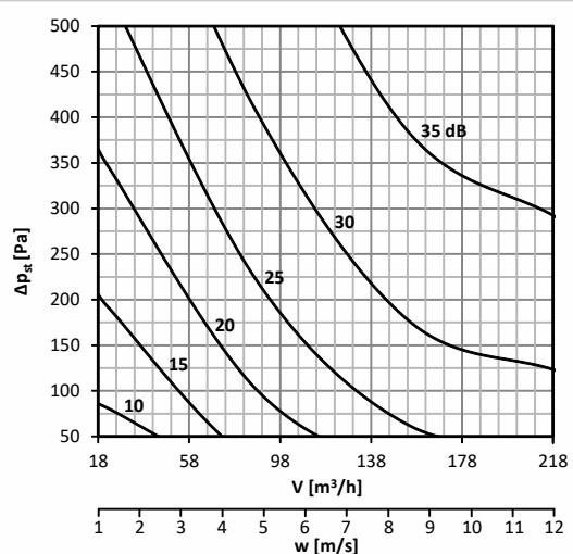
**График 32. Уровень акустической мощности L<sub>WA</sub> [дБ(А)], излучаемой мимо воздуховод DN100, с изоляцией**
