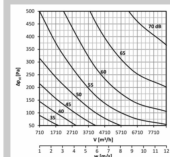
График 30 Уровень акустической мощности L<sub>WA</sub> [дБ(А)], излучаемой мимо воздуховод DN630, без изоляции
