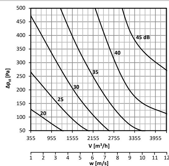
График 43. Уровень акустической мощности Lwa [дБ(А)], излучаемой мимо воздуховод DN400, с изоляцией
