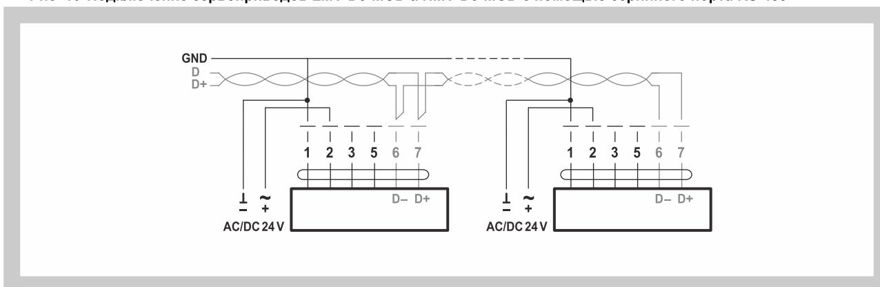
Рис. 11 Сервоприводы LMV-D3-KNX, NMV-D3-KNX, LMV-D3-LON и NMV-D3-LON
