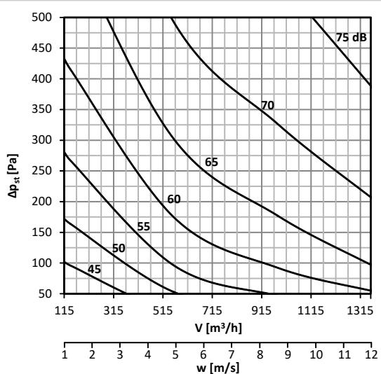
**График 8. Уровень акустической мощности LWA [дБ(А)], выделяемой в воздуховод DN225**
