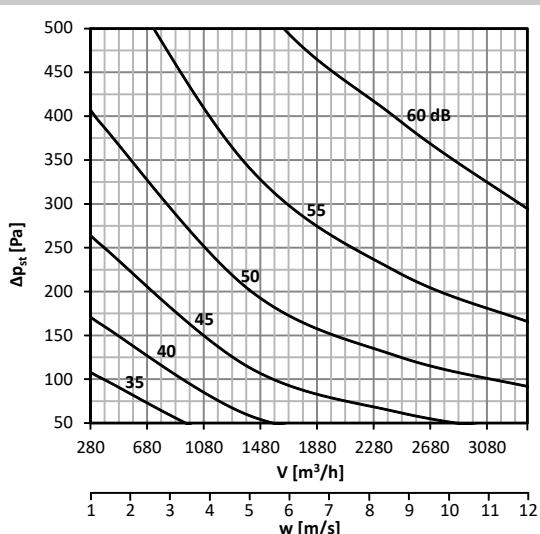
**График 27. Уровень акустической мощности LWA [дБ(А)], излучаемой мимо воздуховод DN355, без изоляции**
