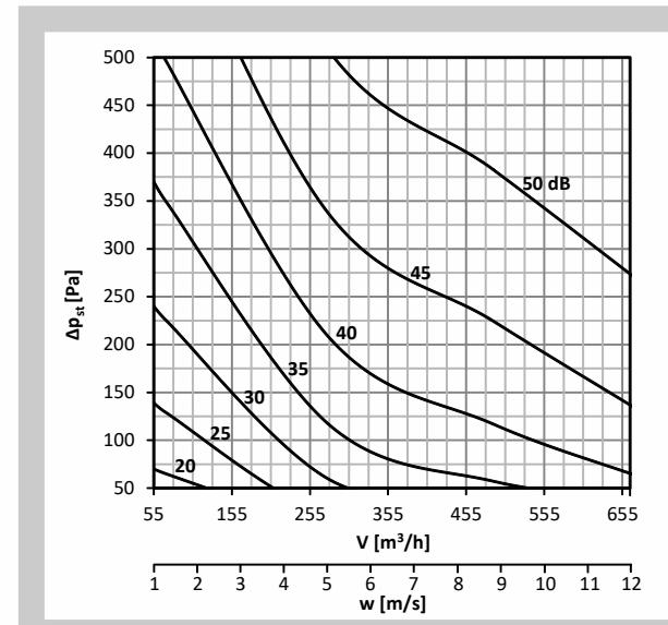
График 20. Уровень акустической мощности LWA [дБ(А)], излучаемой мимо воздуховод DN1160, без изоляции
