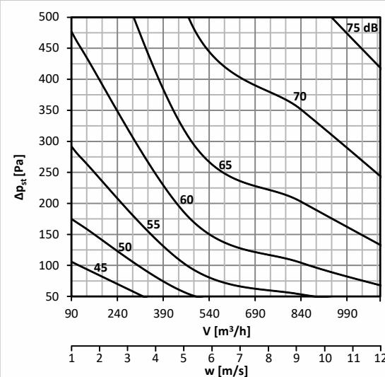
**График 7. Уровень акустической мощности LWA [дБ(А)], выделяемой в воздуховод DN200**
