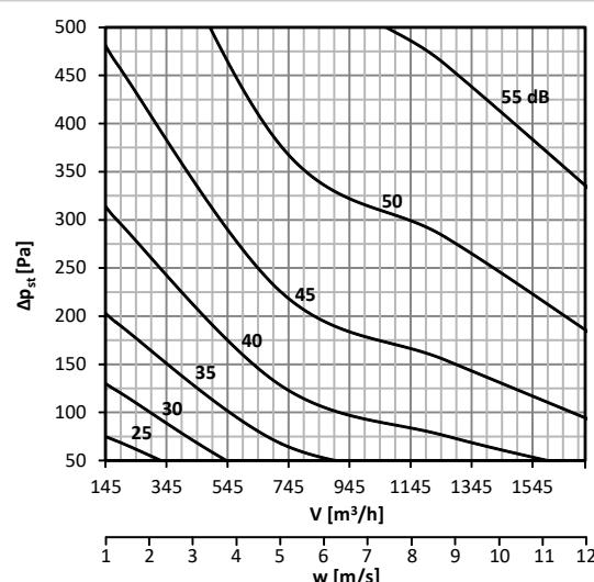
**График 24. Уровень акустической мощности LWA [дБ(А)], излучаемой мимо воздуховод DN250, без изоляции**
