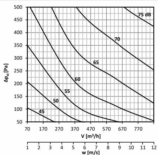
**График 6. Уровень акустической мощности L<sub>WA</sub> [дБ(А)], выделяемой в воздуховод DN180**
