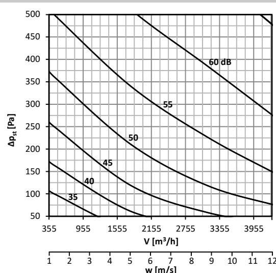
График 28. Уровень акустической мощности L<sub>WA</sub> [дБ(А)], излучаемой мимо воздуховод DN400, без изоляции
