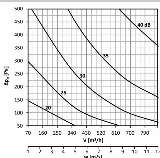
**График 36. Уровень акустической мощности L<sub>WA</sub> [дБ(А)], излучаемой мимо воздуховод DN180, с изоляцией**
