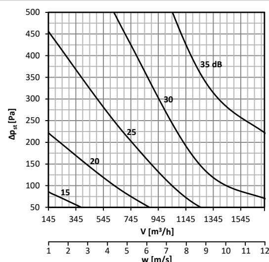
**График 40. Уровень акустической мощности LWA [дБ(А)], излучаемой мимо воздуховод DN280, с изоляцией**
