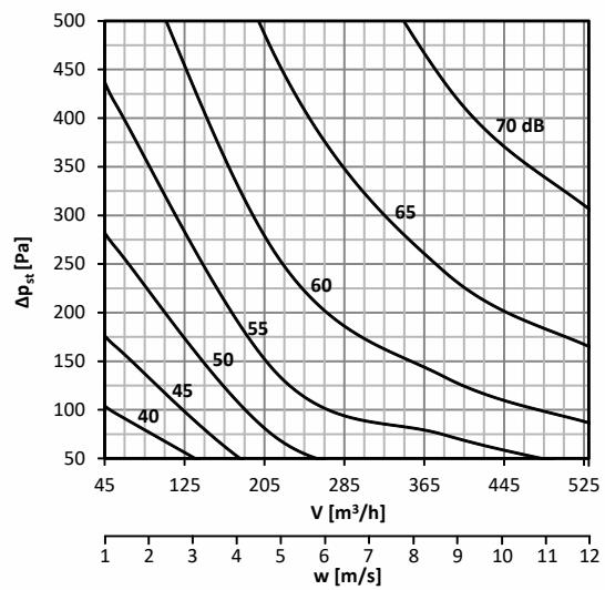
**График 4. Уровень акустической мощности L<sub>WA</sub> [дБ(А)], выделяемой в воздуховод DN140**
