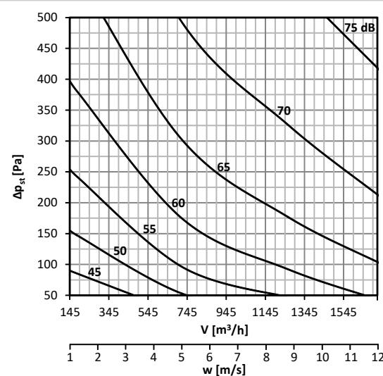
**График 9. Уровень акустической мощности LWA [дБ(А)], выделяемой в воздуховод DN250**
