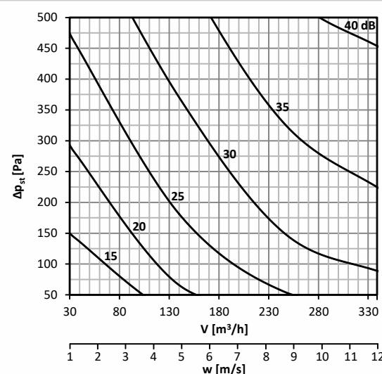
**График 33. Уровень акустической мощности L<sub>WA</sub> [дБ(А)], излучаемой мимо воздуховод DN125, с изоляцией**
