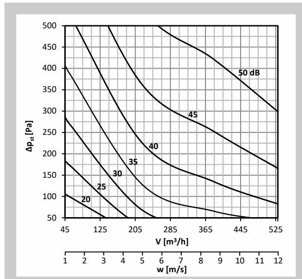
График 19. Уровень акустической мощности LWA [дБ(А)], излучаемой мимо воздуховод DN140, без изоляции
