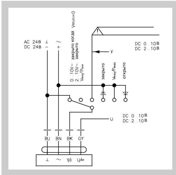
Рис. 28 Регулировка 227VM-024-...-MP и 227PM-024-...-MP
