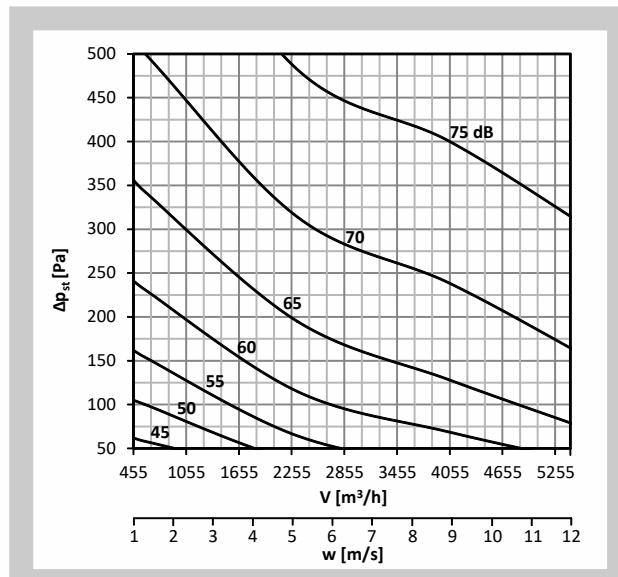
График 14. Уровень акустической мощности  $L_{WA}$  [дБ(А)], выделяемой в воздуховод DN500
