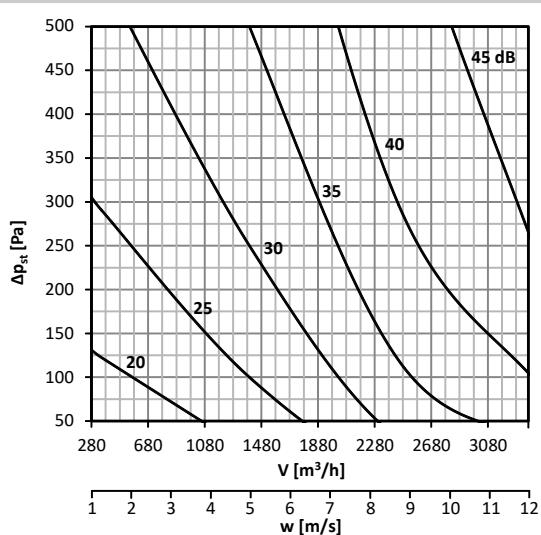
**График 38. Уровень акустической мощности LWA [дБ(А)], излучаемой мимо воздуховод DN225 с изоляцией**
