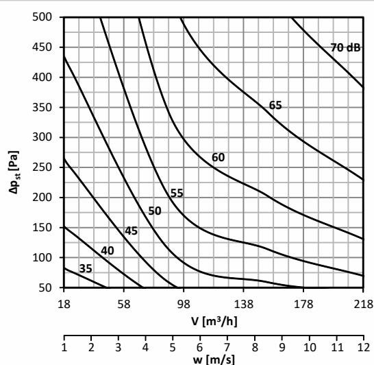
**График 2. Уровень акустической мощности L<sub>WA</sub> [дБ(А)], выделяемой в воздуховод DN100**
