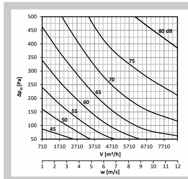
График 15. Уровень акустической мощности  $L_{WA}$  [дБ(А)], выделяемой в воздуховод DN630
