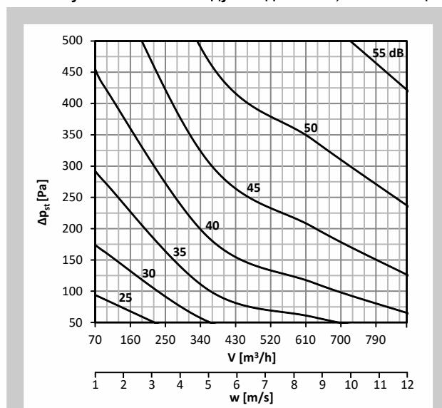
График 21. Уровень акустической мощности LWA [дБ(А)], излучаемой мимо воздуховод DN180, без изоляции
