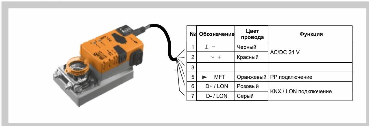
Рис. 12 Подключение сервоприводов LMV-D3-KNX и NMV-D3-KNX
