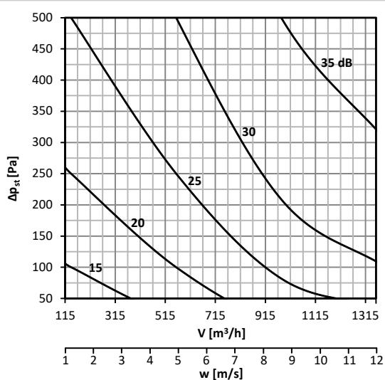
**График 39. Уровень акустической мощности LWA [дБ(А)], излучаемой мимо воздуховод DN250, с изоляцией**
