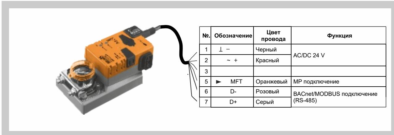
Рис. 10 Подключение сервоприводов LMV-D3-MOD и NMV-D3-MOD с помощью серийного порта RS-485
