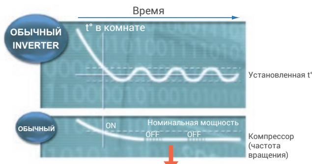
Менее передовая технология не регулирует циклы ВКЛ/ВЫКЛ.
