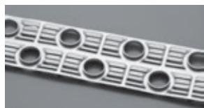
Оптимизация расположения медных трубок и формы оребрения позволила уменьшить сопротивление воздушного потока. Эффективность теплообменника повышена на 33%. Новая форма оребрения обеспечивает одновременно максимальный расход воздуха, минимальное сопротивление и высокий уровень теплосъема.
