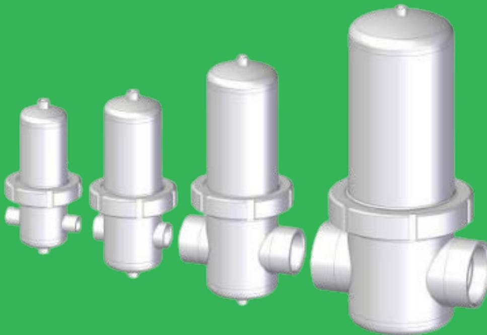
Корпуса P-EGS предназначены для очистки пара для различных областей применения. Благодаря оптимизированной конструкции данные корпуса обеспечивают низкое дифференциальное давление при высокой пропускной способности. В сочетании с различными фильтроэлементами Donaldson P-GSL N они обеспечивают оптимальное решение практически для любого применения.
