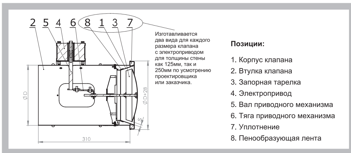
Рис. 3 Устройство клапана противопожарного PVM - E90 с электроприводом Belimo (установка электропривода параллельно оси клапана) – В – вертикальная установка
