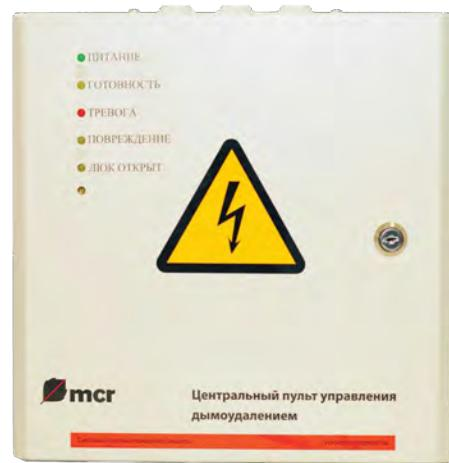
Центральный пульт имеет модульную конструкцию, благодаря чему возможно построение больших систем. Пульт производится в 2 основных исполнениях, в основе которых лежат модули с током нагрузки 5А и 8А: от 5А до 20А (4×5А) или от 8А до 32А (4×8А). Пульты, с модулями на ток нагрузки 8А должны применяться исключительно в системах гравитационного дымоудаления.
