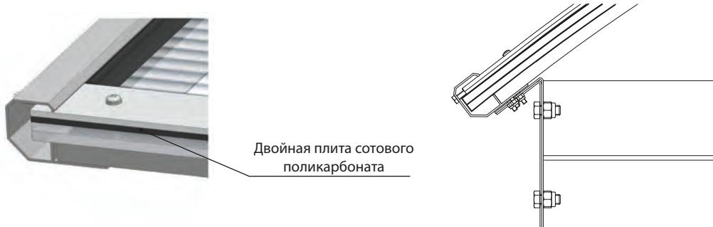
*Сечение зенитного фонаря с заполнением двойной плитой сотового поликарбоната*
