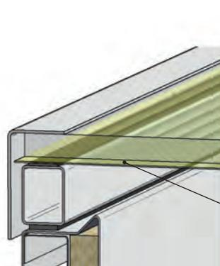
плита сотового поликарбоната + полиэфирная плита
