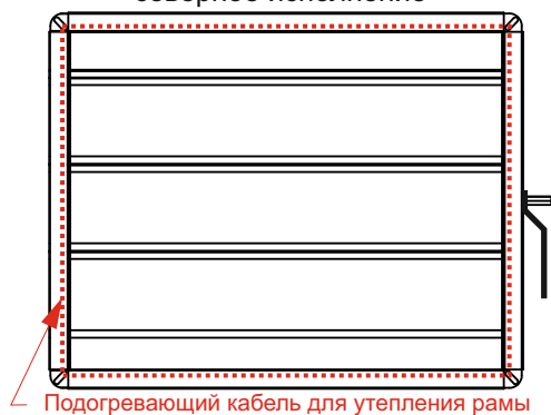
РЭД-УВК-Кан-Р-Сев Канальный с ручной регулировкой северное исполнение
