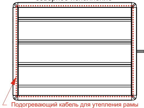
РЭД-УВК-Кан-ПП-Сев Канальный с площадкой под привод северное исполнение
