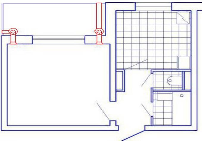
Рис. 20. Пример размещения двух приборов УВРК-50МК в однокомнатной квартире
