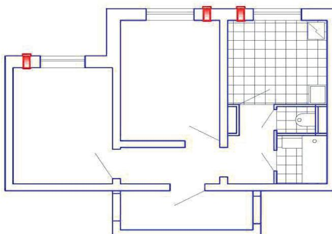
Рис.19. Пример размещения трех приборов УВРК-50М (МА) в двухкомнатной квартире (при монтаже прибора на кухне, произвести подключение к кухонной вытяжке)
