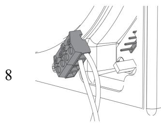
Подключите клеммы на плату клеммного отсека согласно маркировке.
