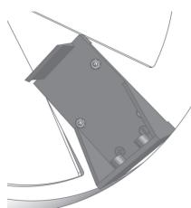
Для замены батареи аварийного закрывания клапана необходимо демонтировать декоративную решетку и фильтр. Извлечь из держателя батарею. При необходимости заменить на новую, соблюдая полярность как показано на рис 25. Используйте батареи РР3 напряжением 9 В.
