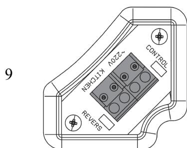
При монтаже нескольких приборов в едином вентилируемом помещении выберите положение джампера синхронизации «REVERS» на плате клеммной колодки, как указано на рисунке.
