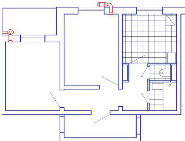
Рис. 21. Пример размещения двух приборов УВРК-50МК в двухкомнатной квартире
